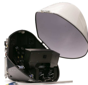
Abbildung 10.3: Bewegungssimulator: Roboterkanzel mit Pilotenarbeitsplatz. Die Bewegungsvorgabe wird in der gezeigten Variante durch einen Steuerknüppel eingegeben, Quelle: www.dlr.de , Lizenz: CC BY 3.0.
