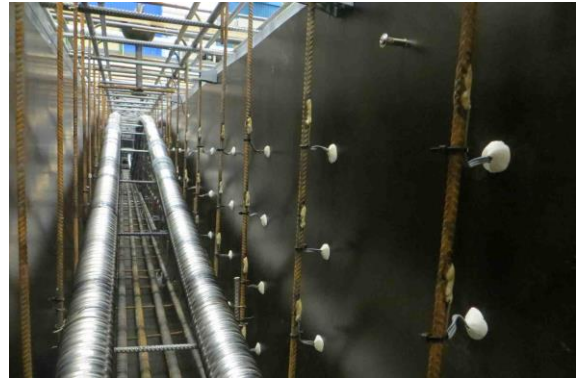
Bild A 1-20: DMS-Kabelführung aus einem Versuchsträger
