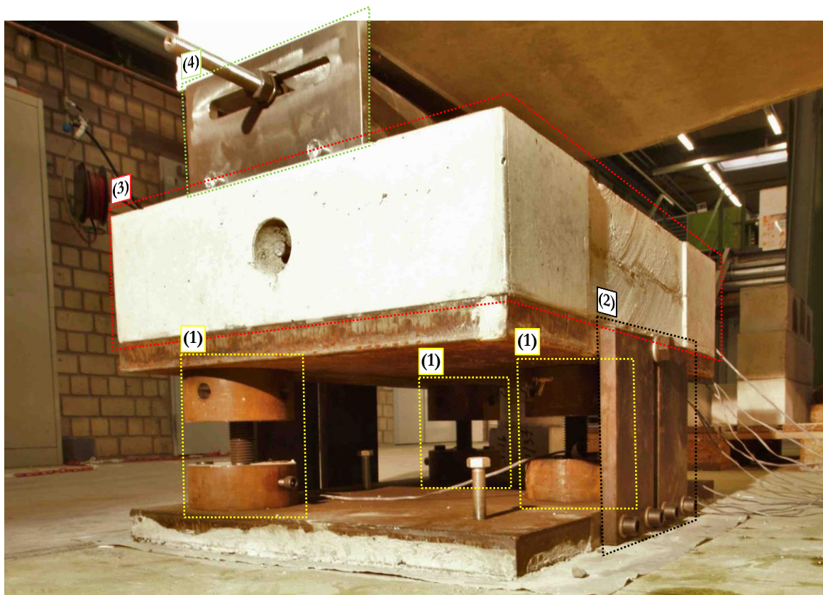
Bild A 1-13: Kraftmessdose (Eigenkonstruktion) zur Messung von Normalkräften in Richtung der Gewindestange
