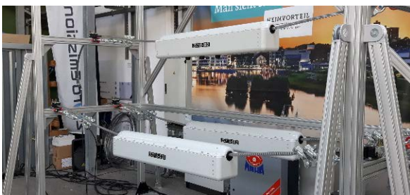
Gerüst mit Leiterseilen und DSRs
