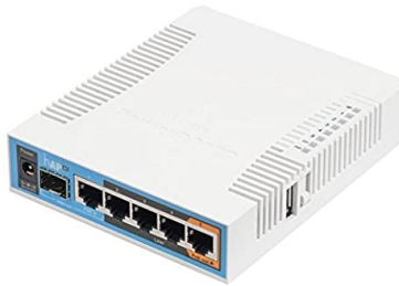
Abbildung 8: Router RB962UiGS-5HacT2HnT der Firma Mikrotik
