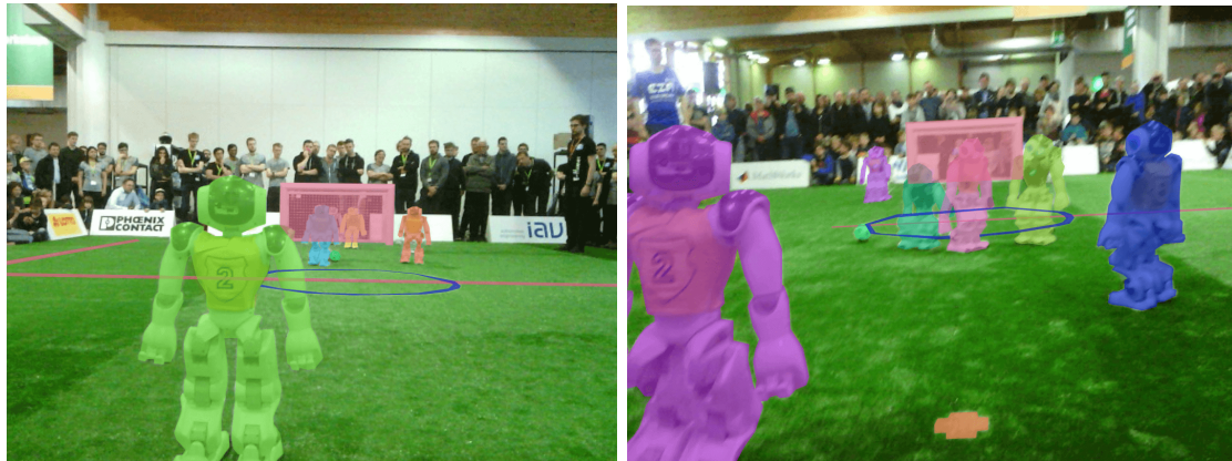
Abbildung 2.12: Beispiele segmentierter Bilder. Roboter haben als verschiedene Instanzen auch verschiedene Farben, gehören aber zur gleichen Klasse
