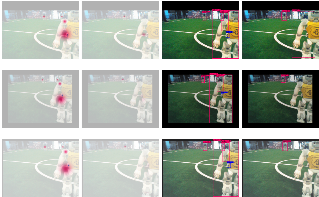
Abbildung 2.7: Ergebnisse der CenterNet-Experimente an einem zweiten Beispielbild. Von links nach rechts: Ground Truth Heatmap, Predicted Heatmap, Ground Truth Bounding Boxes, Predicted Bounding Boxes. Von oben nach unten: Die drei Experimente in der Reihenfolge der Durchführung. Die Bilder werden durch diverse Maßnahmen augmentiert, weshalb die Bildausschnitte nicht absolut identisch sind. Das Bild stammt aus den Testdaten und wurde nie zum Training verwendet.
