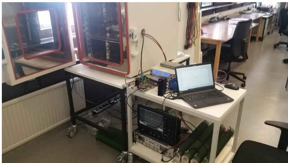
Abbildung 3.29: Vollständiger möglicher Versuchsaufbau des Lichtbogenprüfstands.
