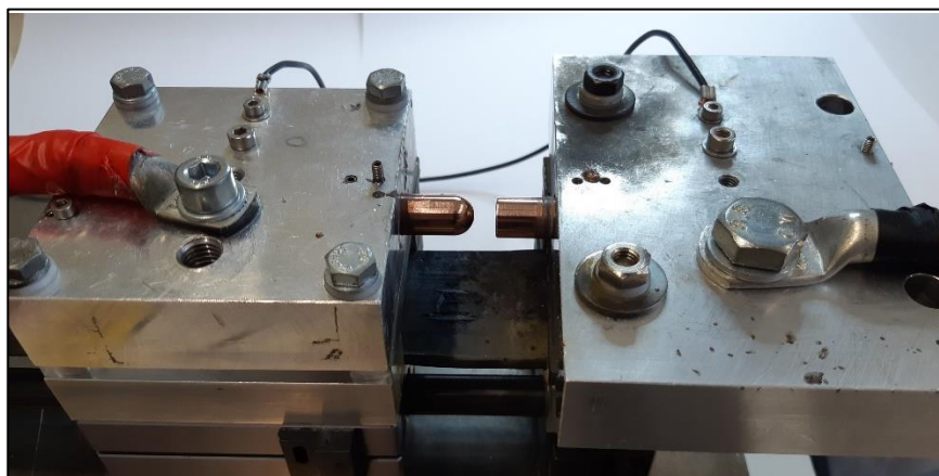
Abbildung 3.27: Elektrodenadapter mit Kupferelektroden des Lichtbogenprüfstands.
