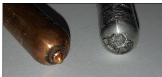
Abbildung 3.42: Exemplarische Darstellung der Deformation an Kupfer- und Aluminiumelektroden nach mehreren Lichtbogenversuchen.
