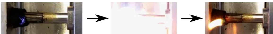
Abbildung 5.14: Links: Lichtbogenentstehung mit Gewebepband umwickelt. Mitte: Lichtbogen. Rechts: Lichtbogen verloschen, Gewebepband entzündet.
