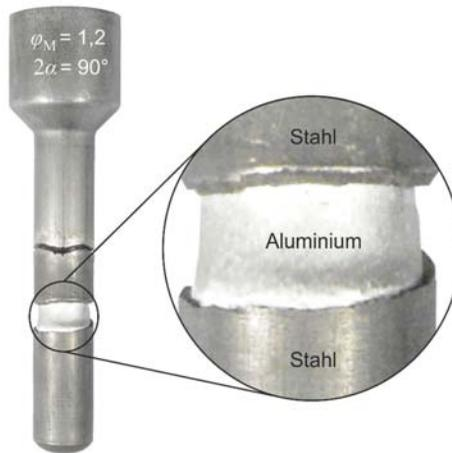
**Bild 5.12:** Fehlerhaftes Bauteil mit Rissbildung am Bauteilschaft
