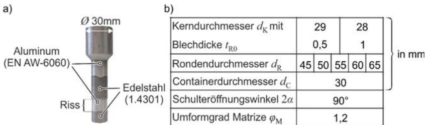
**Bild 4.3:** a) Bauteil mit gerissener Ronde und b) Parameter der experimentellen Studie zum Tiefzieh-Verbundfließpressen nach (Hänisch et al., 2013)
