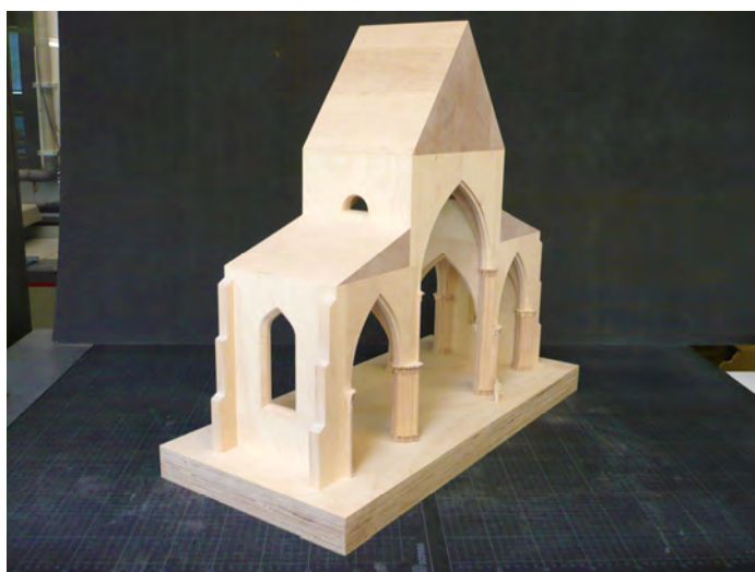
Abb. 45 a-c – Detailmodell Querschnitt Langhaus-Joch , Maßstab 1:50, Birke, 53,5 (Mittelschiff) x 28,2 (Seitenschiffe) x 58,9 x 17,5 cm, Grundplatte: 4,5 x 29,8 x 64,7 cm, Modellbau: Felix Florian. (© ak)
