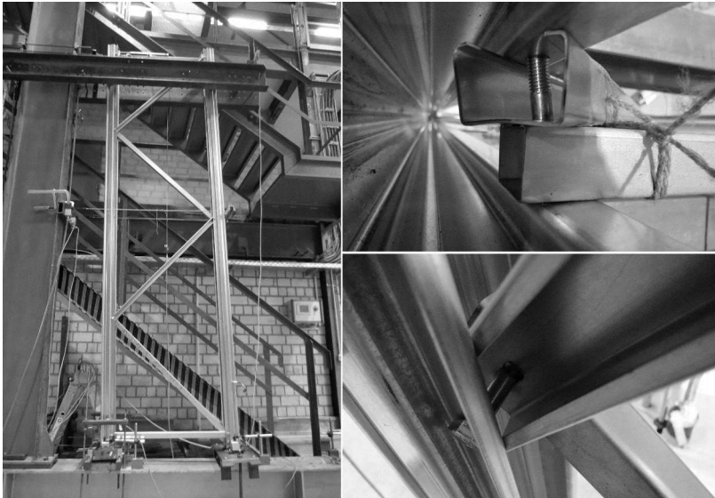
Bild 3.22: Versagensmechanismus Serie C – Schraubenbiegung und Lochleibung
