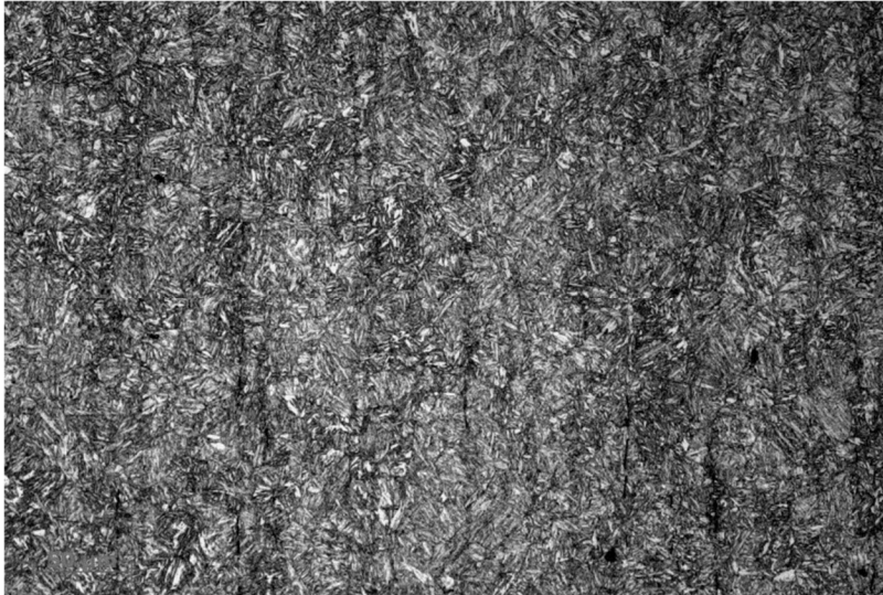
Bild 3.84: Gefügeausbildung im Kernbereich (200x), exemplarisch M12x100-8.8 – ISO 4014
