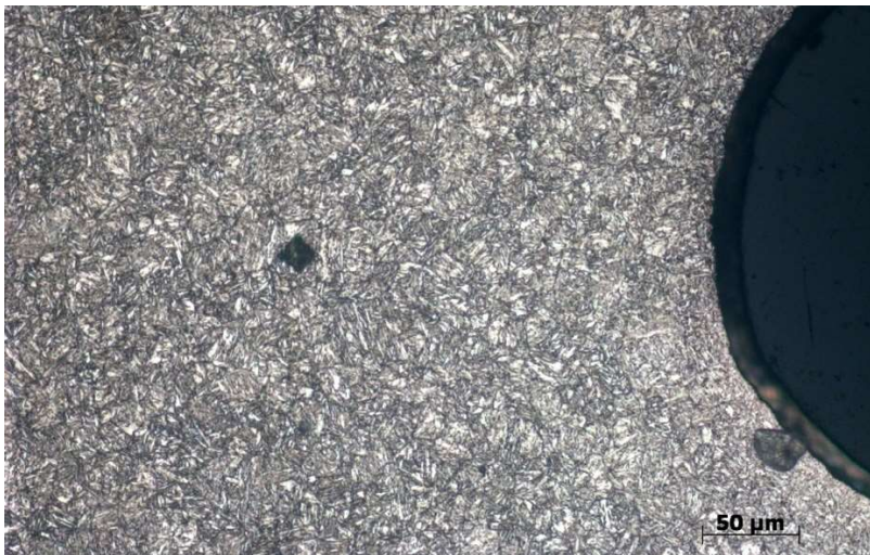
Bild 3.83: Gefügeausbildung im Gewindegrund (200x), exemplarisch M8x100-8.8 – ISO 4014
