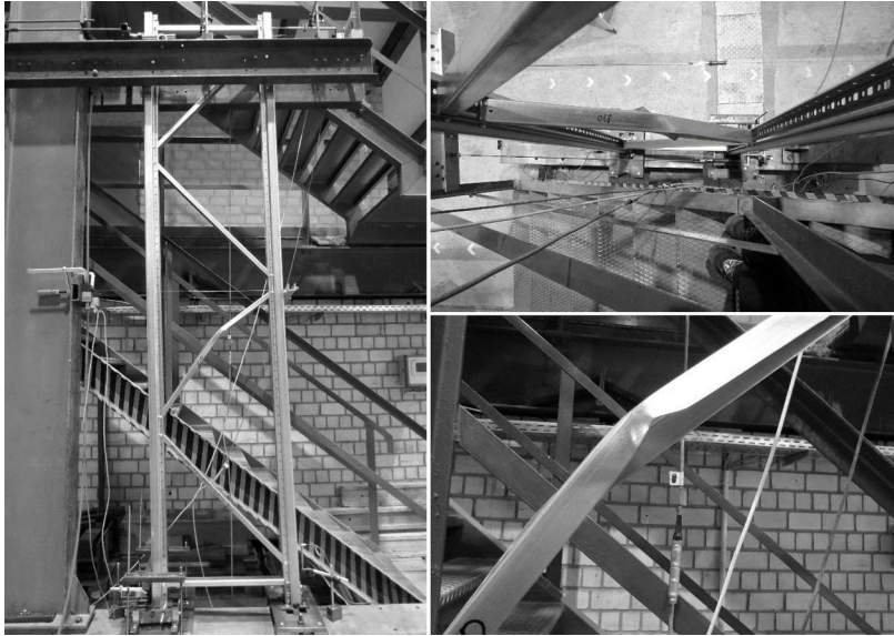
Bild 3.21: Versagensmechanismus Serie B – Knicken der druckbeanspruchten Diagonalen
