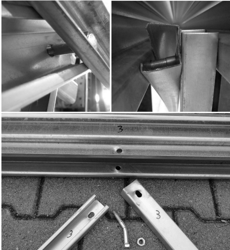
Bild 3.14: Versagensmechanismus Serie C – Schraubenbiegung und Lochleibung
