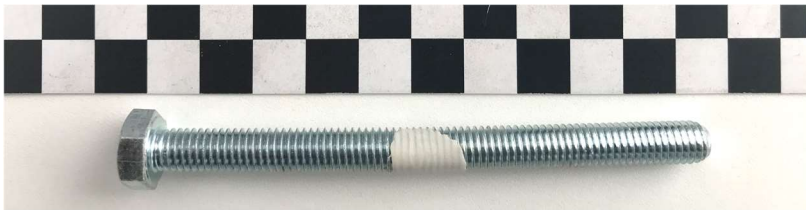
Bild 3.81: Schraube mit Gewinde bis zum Kopf aus der Versuchsserie A – Messstelle für Wegaufnehmer Gewindgänge mit Zweikomponentenkleber verfüllt
