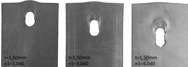
Variation des Randabstandes in Krafrichtung für Schrauben M10-8.8
