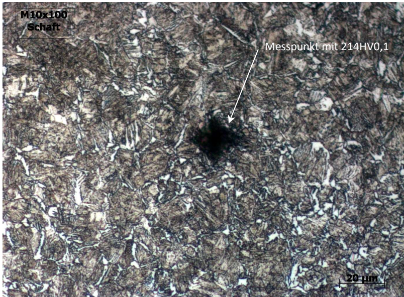
Bild 3.87: Gefügeausbildung und Eindruck einer Härtemessung mit 214HV 0,1 (500x) mit Ferritphasen, exemplarisch M10x100-8.8 – ISO 4014
