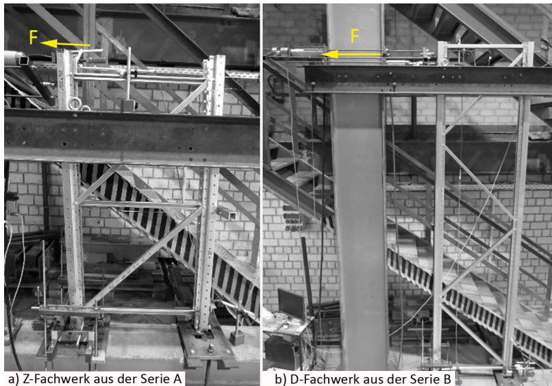
Bild 3.17: Gesamtansicht des Versuchsaufbaus für die Rahmensubversuche nach AS 4084
