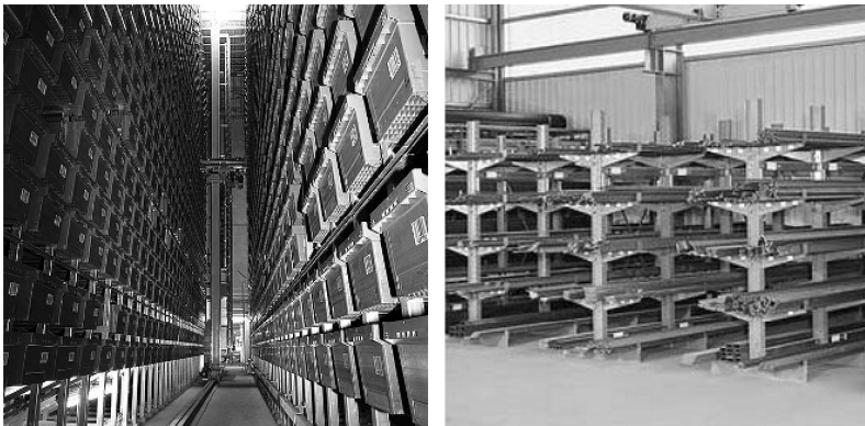
Bild 2.2: Beispiele für Zeilenregallagerungen nach ten Hompel et al. [97] (links: Behälterregal mit großer Bauhöhe; rechts: Kragarmregal)
