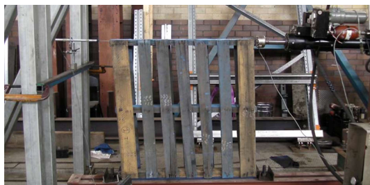
Bild 4.49: Experimentelle Ermittlung der Schubsteifigkeit von hölzernen Paletten aus [41]
