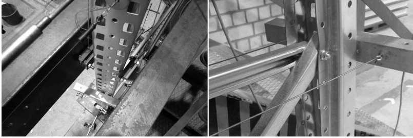
Bild 3.20: Versagensmechanismus Serie A – Tordierung der dünnwandigen offenen Stützen
