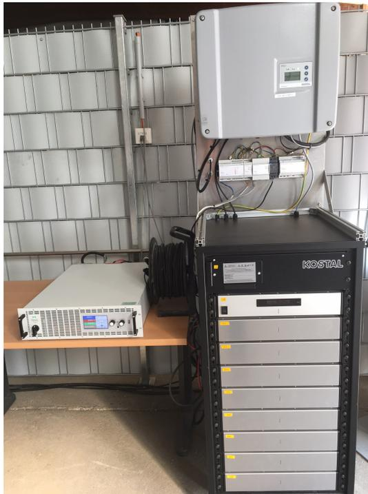
Aufnahme des Batteriespeichersystems, PV-Simulators und den entwickelten Prototypen (Unterfrequenzrelais und Speichercontroller) für die Durchführung des Feldversuchs
