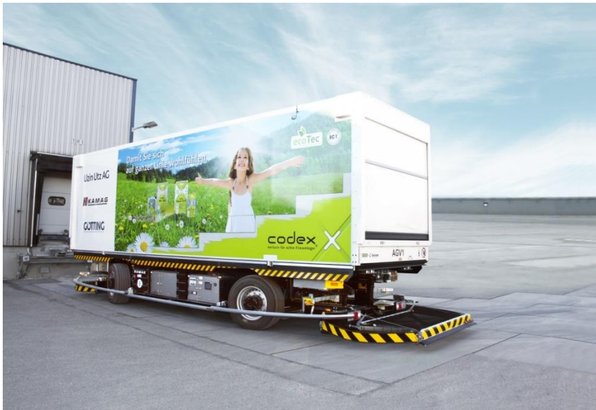
Abbildung 2-4: AGV mit nicht vorgegebenem Fahrweg im Außenbereich (Abbildung mit freundlicher Genehmigung der Transporter Industry International Sales GmbH & Co. KG)
