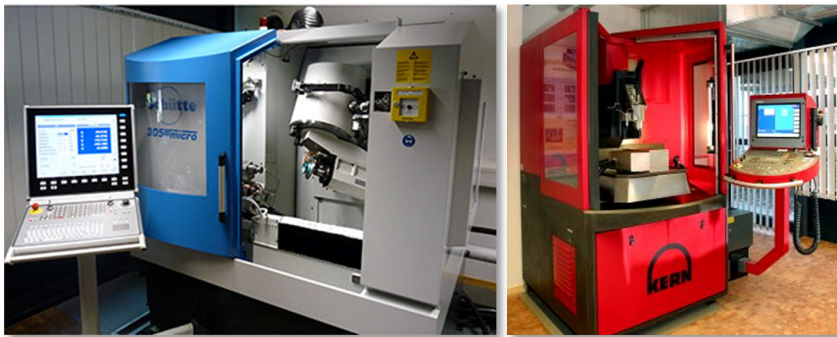
Abbildung 4.4: Eingesetzte Maschinen zur Werkzeugmodifikation: Schütte 305 micro (links) und Kern HSPC 522 (rechts)
