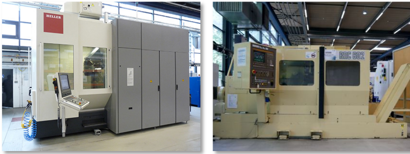
Abbildung 4.2: Eingesetzte Versuchsmaschinen: 5-Achs-BAZ Heller FT 4000 (links), CNC-Drehmaschine Monforts RNC 602 (rechts)
