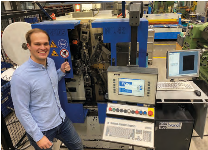
P. Rethmann, Mitarbeiter der Abteilung Profil- und Blechumformung, zeigt den neuen Versuchsaufbau zum Federwinden
