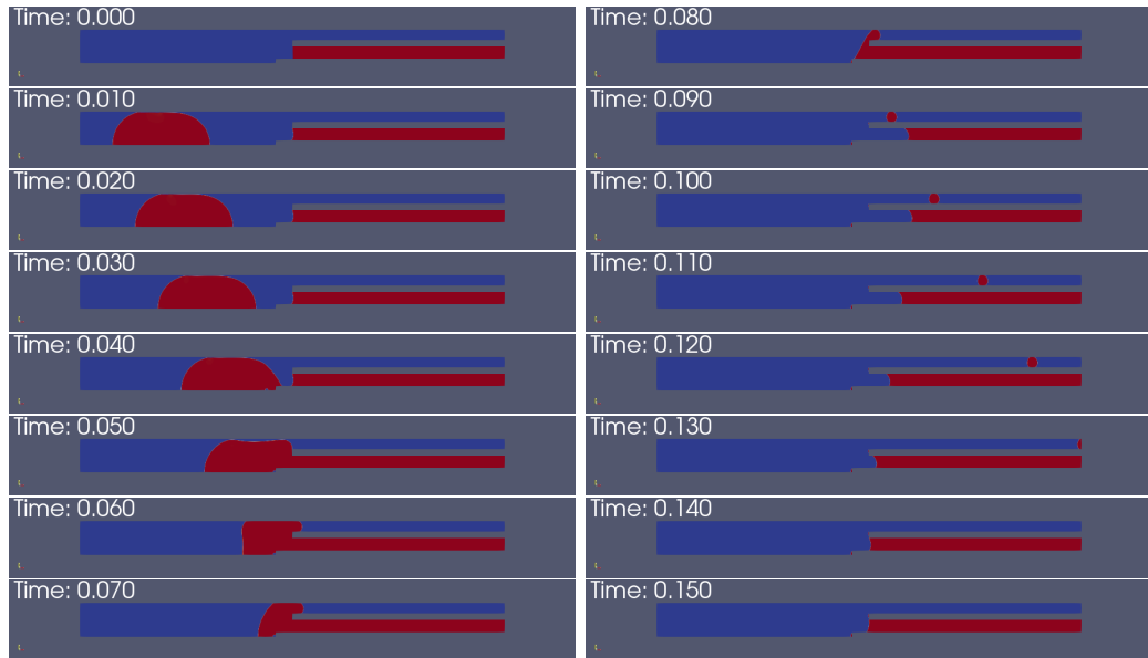
Abbildung 4.4: Zeitlicher Verlauf der simulierten unsauberen Phasentrennung für die Werte \bar{u} = 0,55 \text{ m/s} und \sigma = 32 \text{ mN/m} in den ersten 150 ms.
