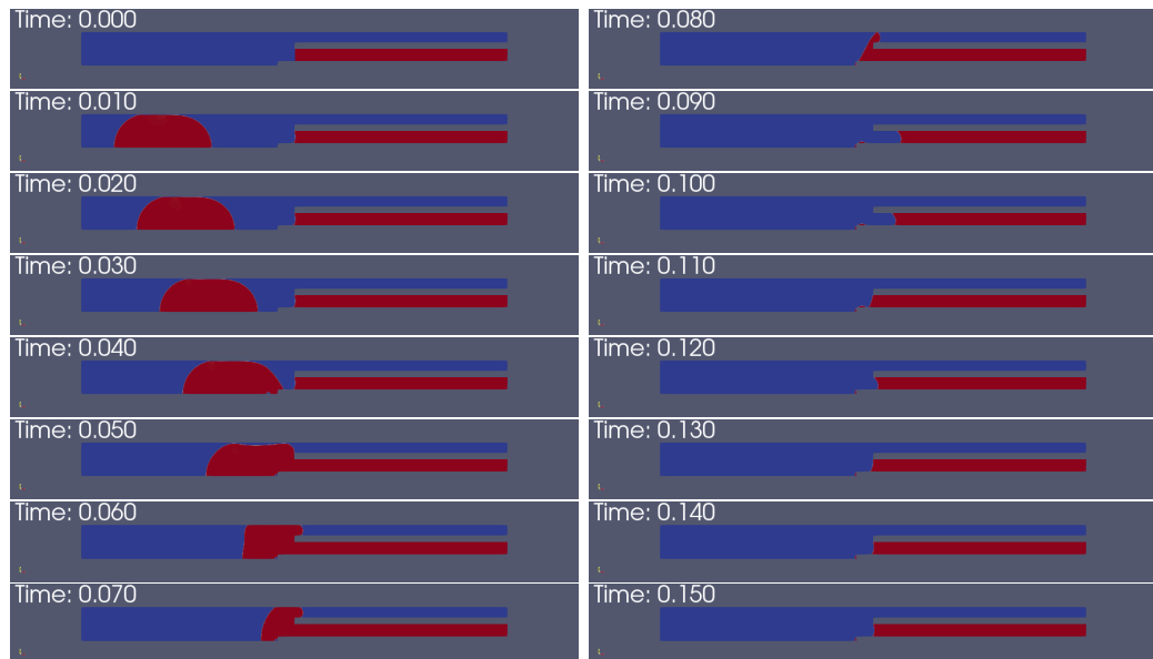
Abbildung 4.6: Zeitlicher Verlauf der simulierten sauberen Phasentrennung für die Werte \bar{u} = 0,55 \text{ m/s} und \sigma = 35 \text{ mN/m} in den ersten 150 ms.
