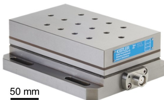
Bild 4.21: Kraftmessplattform für die Messung der Kraftkomponente beim Plan-MAP
