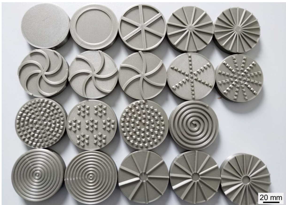
Bild 4.10: Unterschiedliche additiv-gefertigte Deckelstrukturen für den Werkzeugtyp A
