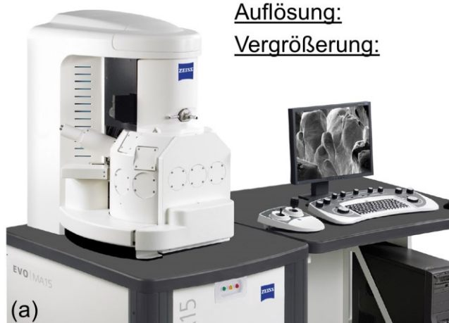
Bild 4.22: Rasterelektronenmikroskop für die Untersuchung des magnetabrasiven Pulvers: (a) Außenansicht, (b) Innenraum
