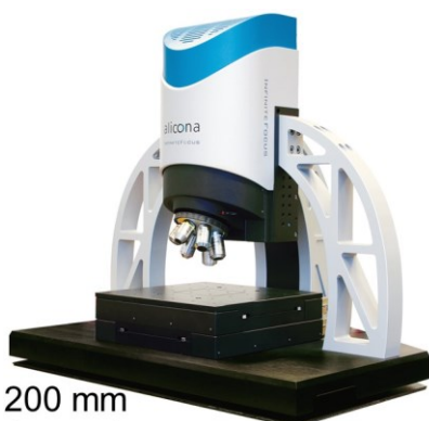
Bild 4.25: Optisches Mikroskop für die Beurteilung der Oberflächentopographie
