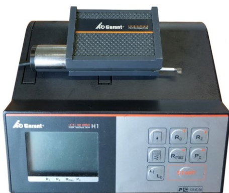
Bild 4.23: Mobiles taktiles Rauheitsmessgerät für die Messung der Oberflächengüte nach dem Fräsen und magnetabrasiven Polieren
