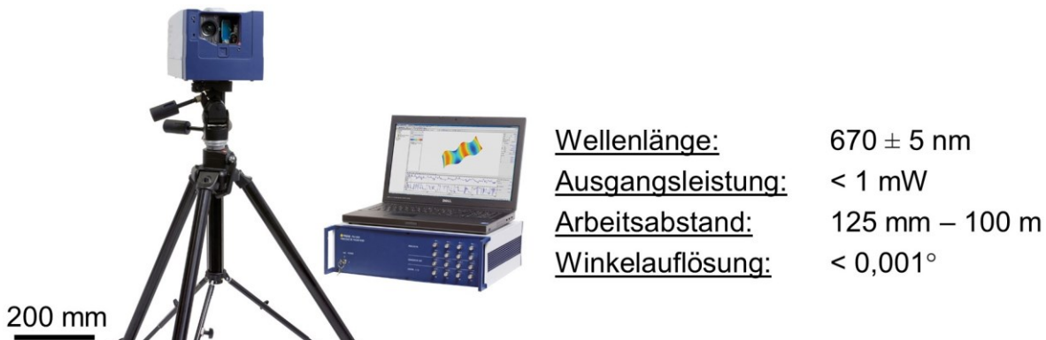
Bild 4.20: Vibrometer für die Messung des Schwingungsverhaltens des MAP-Werkzeugtyps F während der Ultraschallanregung
