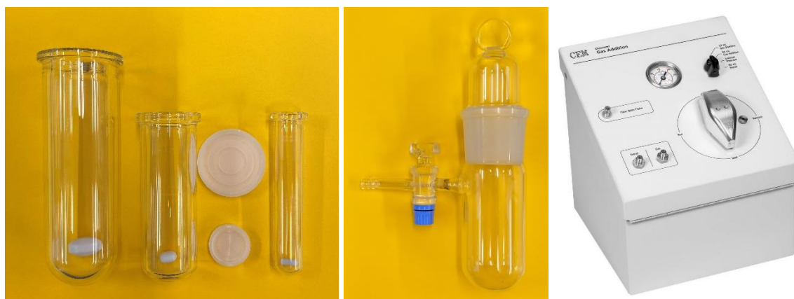
Abb. 4.3: Mikrowellengefäße in den Größen 80 mL, 35 mL und 10 mL (links); Apparatur zum Ausheizen, Befüllen und Verschließen von Mikrowellengefäßen unter Argon (Mitte); GASADDITION-TOOL der Firma CEM zur Aufrechterhaltung der Argonatmosphäre in 80 mL Mikrowellengefäßen. [97]
