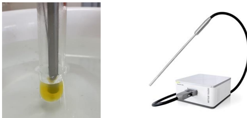
Abb. 4.44: REACTIR-Messsonde in einem Schlenkrohr (links); REACTIR der Firma METTLER TOLEDO (rechts). [101]
