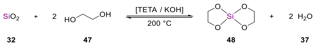
Schema 2.21: Depolymerisation von SiO 2 mit Ethylenglycol, katalysiert durch Triäthylentetramin und Kaliumhydroxid. [66]
