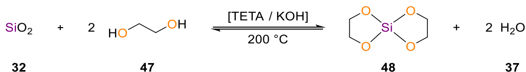
Schema 4.76: Depolymerisation von Siliciumdioxid mit Ethylenglycol, katalysiert durch Triethylenetetramin und Kaliumhydroxid. [66]
