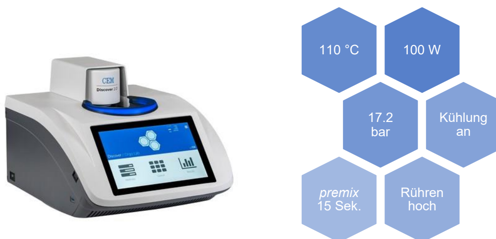
Abb. 4.2: Synthesemikrowelle DISCOVER 2.0 der Firma CEM (links); [96] Parameter der Mikrowelle zur Darstellung von ( tert -Butylaminomethyl)triethoxysilan ( 87 ) (rechts).
