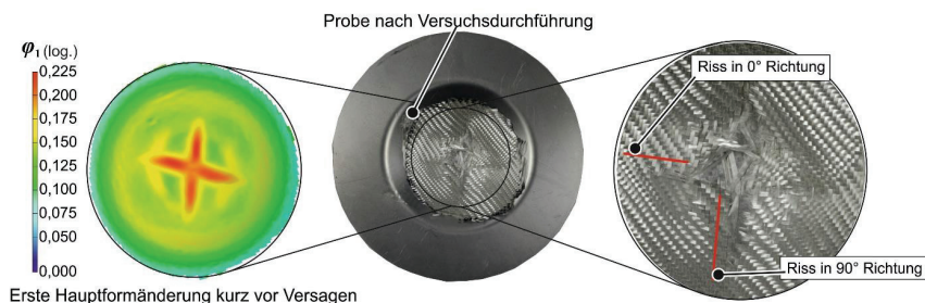
Bild 4.25: Dehnungslokalisation durch Riss im Gewebe.
