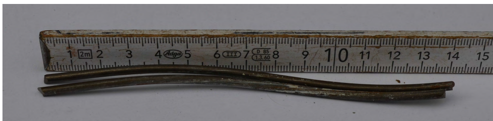
Abb. 6.26.: Länge von zwei doppelt gebrochenen Litzendrähten aus dem Spannglied des Versuchs GS02
