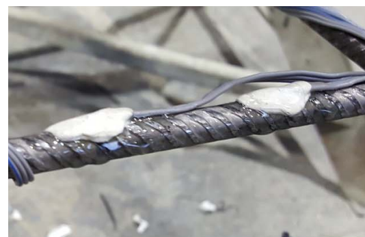
Abb. 3.23.: Fotografie zweier DMS-Messstellen auf Betonstahl \varnothing 12 mm
