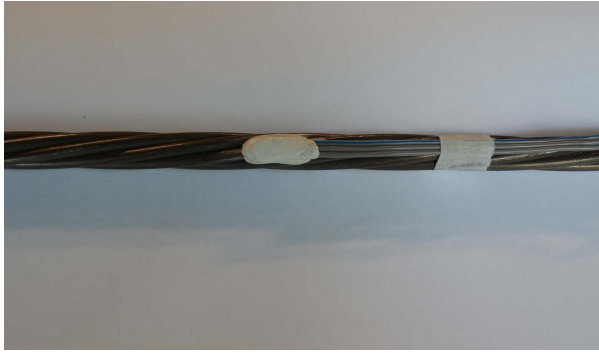
Abb. 3.13.: Vorbereitete DMS-Messstelle mit Schutzschicht auf einer \varnothing 3/8'' -Litze
