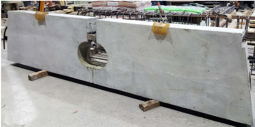
Abb. 3.12.: Aufgerichteter Versuchsträger (Reihe GS) nach dem Ausbau aus der Schalung
