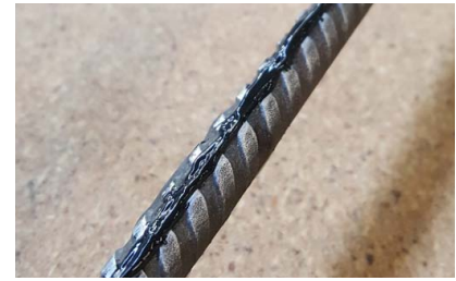
Abb. 3.25.: Bewehrungsstab mit applizierter Glasfaser
