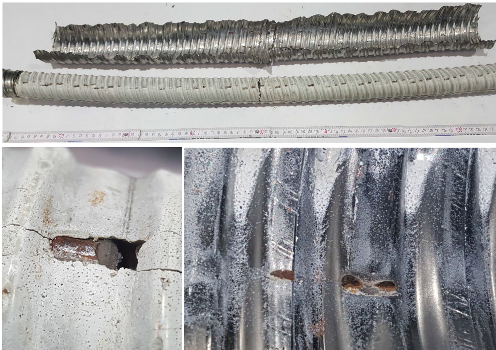
Abb. 3.36.: Reibstellen zwischen Spannstahtlitzten und Hüllrohr (Versuch GL02)
