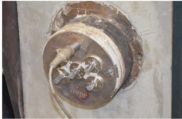
Abb. 3.27.: Beschleunigungsaufnehmer an der Ankerbuchse
