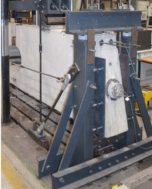
Abb. 3.18.: Auflagerkonstruktion mit eingebautem Versuchsträger
