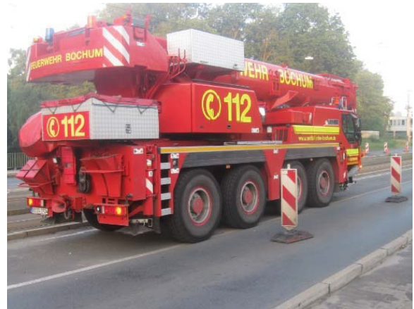
Abb. 6.21.: Überfahrt des 44t Mobilkrans als Probekbelastung
