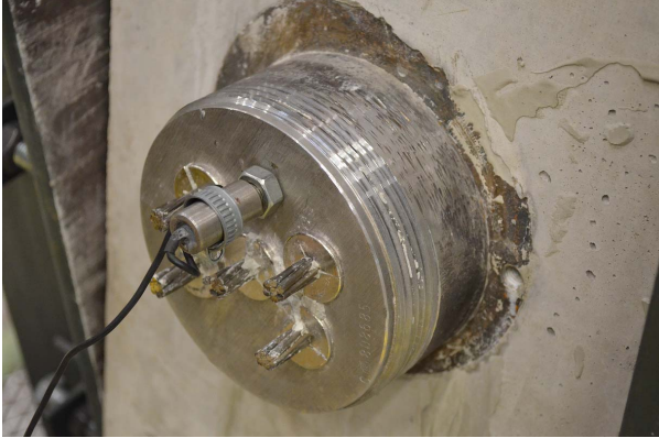
Abb. 3.26.: Mikrofon an der Ankerbuchse
