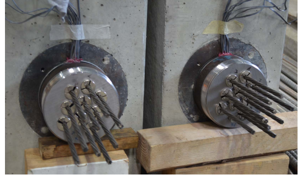
Abb. 3.14.: Kabelführung an der Ankerstelle (Versuchsreihe GR)
