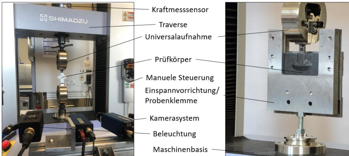
Abbildung 50: Zugprüfstand mit DLJ-Prüfkörper und T-Hybridprüfkörper in Einspannvorrichtung
