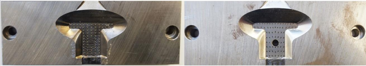
Abbildung 48: Spritzgießwerkzeugeinsätze mit unterschiedlichen Oberflächenstrukturen
