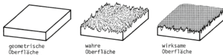
Abbildung 6: Schematische Darstellung der Oberflächenarten: geometrische Oberfläche , wahre Oberfläche und wirksame Oberfläche [Hab09]
