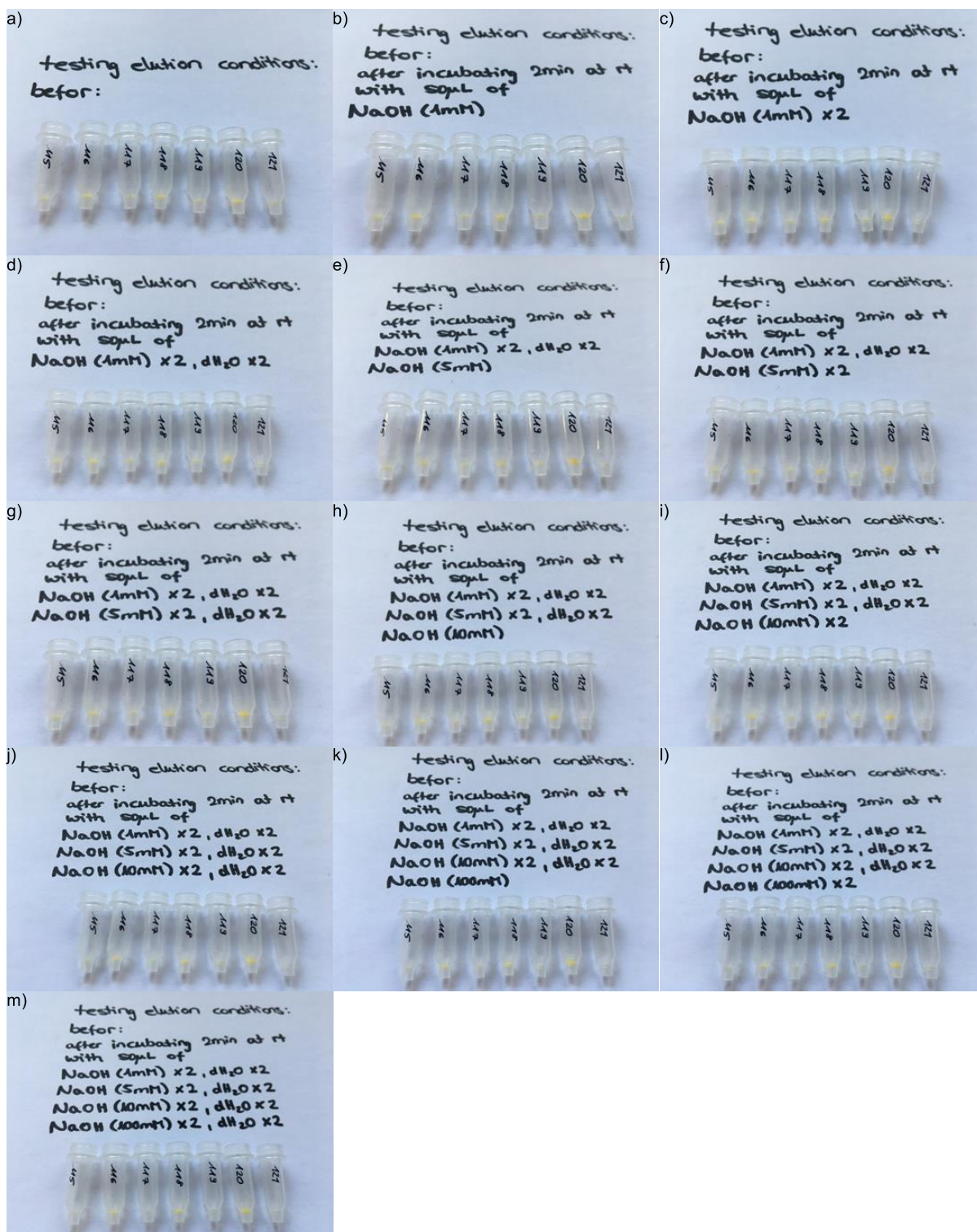
Abbildung 88: Prüfung verschieden konzentrierter wässriger NaOH-Lösungen für die Elution von DNA-13b. Bilder der Mobicols mit der Matrix-DNA-12a/12b (115-121) hergestellt mit den Bedingungen in Tabelle 32 a) vor der Elution und nach der Inkubation (2 min) mit b) - d) wässriger NaOH-Lösung (1 mM); e) - g) wässriger NaOH-Lösung (5 mM); h) - j) wässriger NaOH-Lösung (10 mM); k) - m) wässriger NaOH-Lösung (100 mM).
