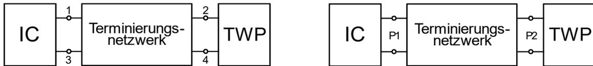
**Abbildung A.3: Benennung der Ports zur Bestimmung der Single-Ended- und Mixed-Mode-S-Parameter**
