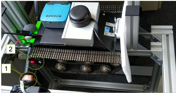
(a) Darstellung des Messstands mit Lasermessgerät (1) und Reflexionsstreifen auf dem abgedunkelten Antriebsrad (2).
