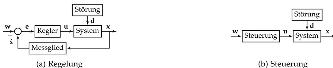
Abbildung 2.1.: Vergleich zwischen Steuerung und Regelung.
