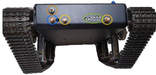
Abbildung 6.5.: Darstellung der Statusleuchten (grün), der Antennenanschlüsse für Satellitenortung (blau) und IEEE 802.11 Wi-Fi (gelb) sowie des Einschalters (orange) am Heck des Roboters.
