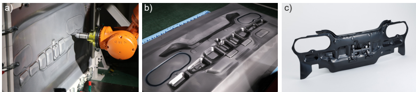
Bild 2.10: a) Fertigung von Karosseriekomponente mittels TPIF, b) Gefertigte Karosseriekomponente, c) Endbearbeitete Karosseriekomponente (N. N., 2023)
