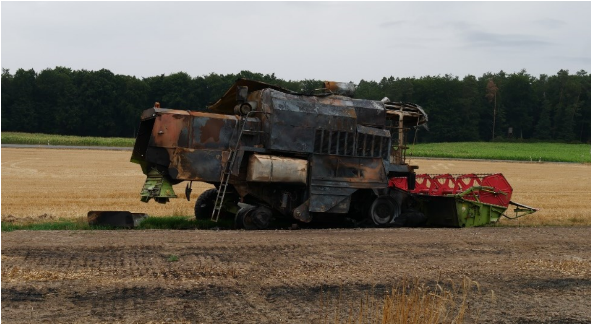
Abbildung 93 Ausgebrannter Mähdrescher unter den Leiterseilen der Freileitung
