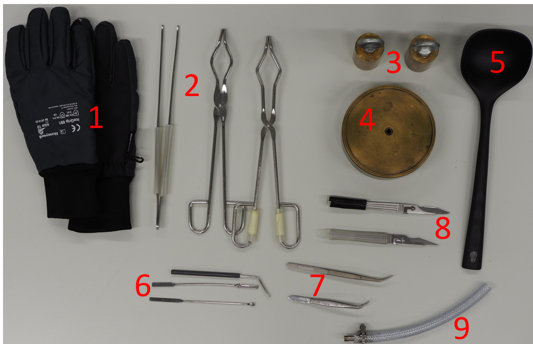
Abbildung 5.2: Zur Präparation der Eisproben verwendete Werkzeuge: 1) vor Kälte schützende Handschuhe, 2 und 7) Pinzetten, Zangen (z.B. Grillzangen), 3) Metallstücke, 4) Kupferblock (Zylinder mit ca. 12 cm Durchmesser und 4 cm Höhe) 5) Suppenkelle, 6) Spatel, 8) Skalpell, 9) Mörser (Metallstab mit etwa 1 cm Durchmesser). Die Griffe der Zangen (2), Skalpell (8) und des Mörsers (9) sind zur Kälteisolation mit Schläuchen versehen. Zusätzlich werden zwei Styroporkisten (innen: L \times B \times H \approx 25 \text{ cm} \times 20 \text{ cm} \times 15 \text{ cm} ) verwendet.
