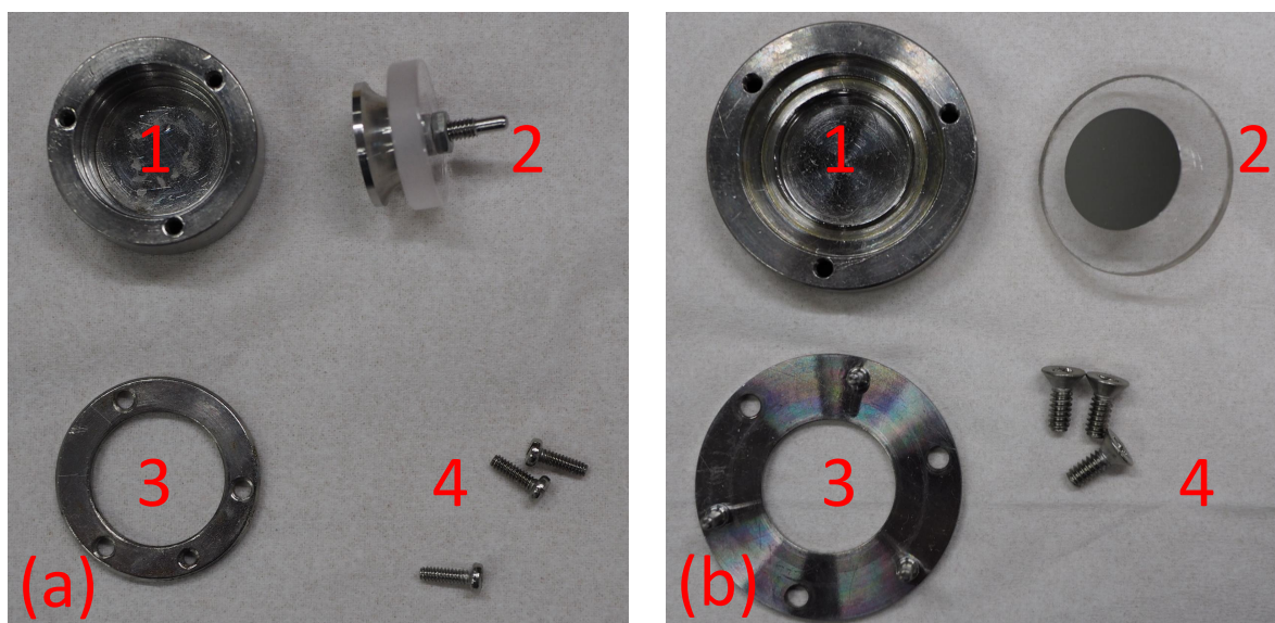
Abbildung 2.2: Dielektrizitätszellen: 1) untere Elektrode (Innendurchmesser 12 mm (a), 18 mm (b)), 2) obere Elektrode mit Saphirscheibe zur Isolierung, 3) Abdeckung, 4) Schrauben zur Fixierung der Abdeckung
