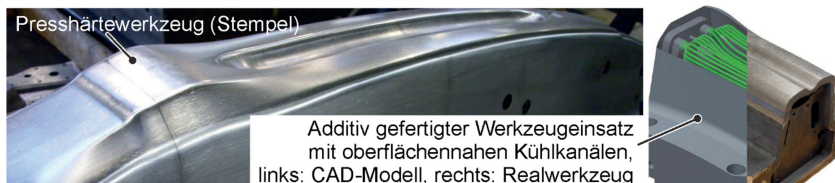
Bild 2.13 Beispiel für ein hybrides Presshärtezeug auf Basis des Selektiven Laserschmelzens (Müller, 2013)
