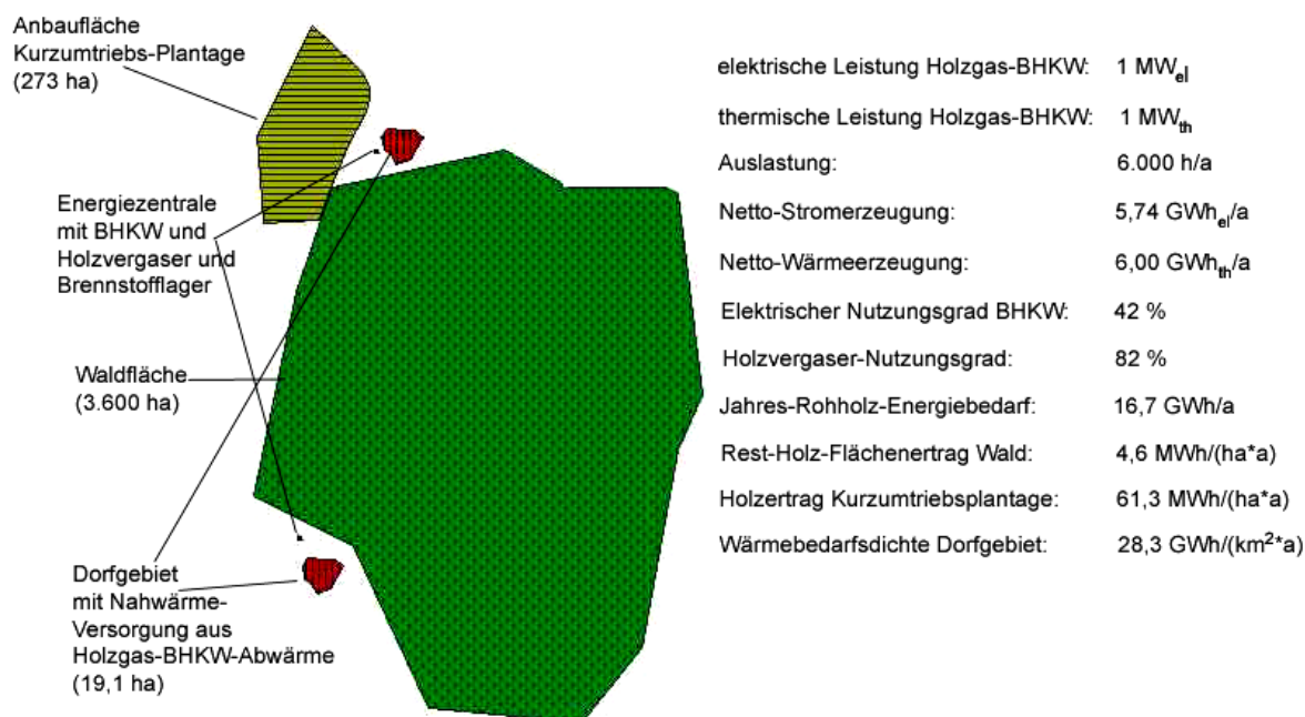
Abbildung 22: Flächenverhältnisse für die Brennstoffgewinnung, die Energieumwandlung und die Wärmeversorgung am Beispiel der Wärme-Auskopplung aus einem Holzgas-BHKW
