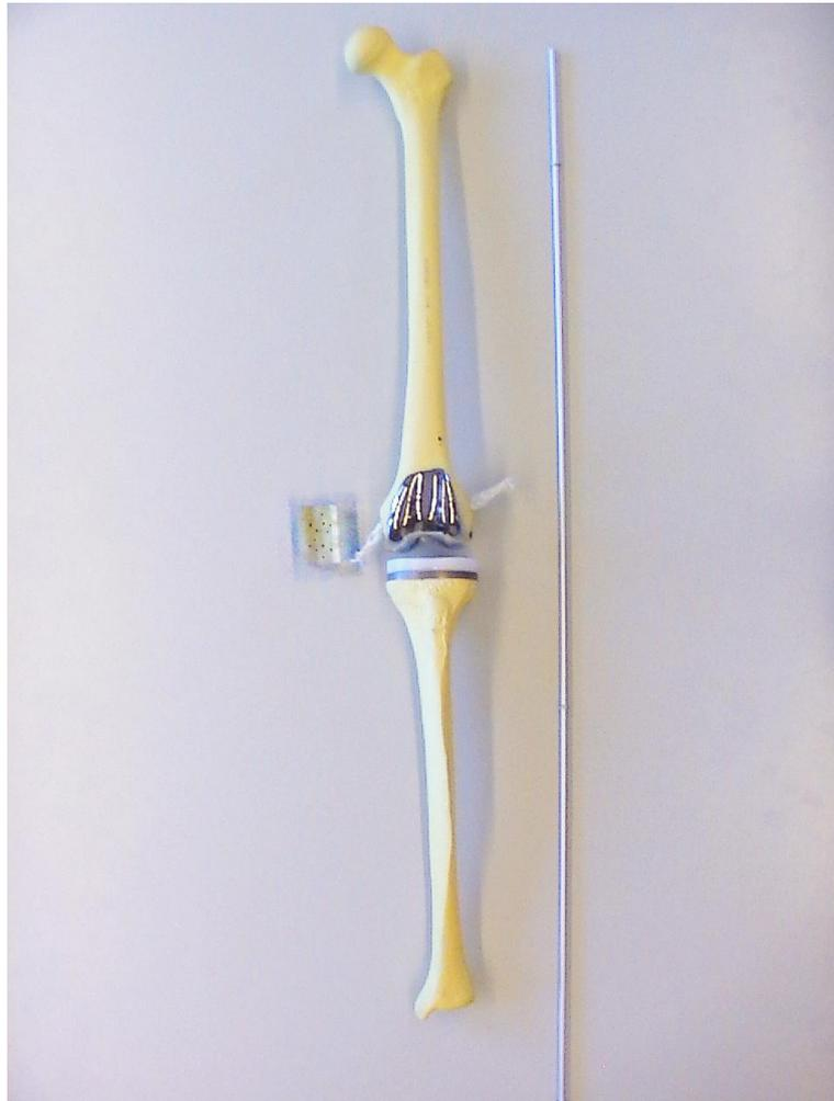
Abbildung 2.3: Der Stab wird neben den Knochen gelegt und darf während der gesamten Aufnahme-prozedur nicht verschoben werden. Der Quader/Diamant wird für jeden anatomischen Bereich, der aufgenommen wird, entweder neben die Hüfte, neben das Knie oder neben den Knöchel gelegt. Für die Abbildung wurde der Quader neben das Knie gelegt.
