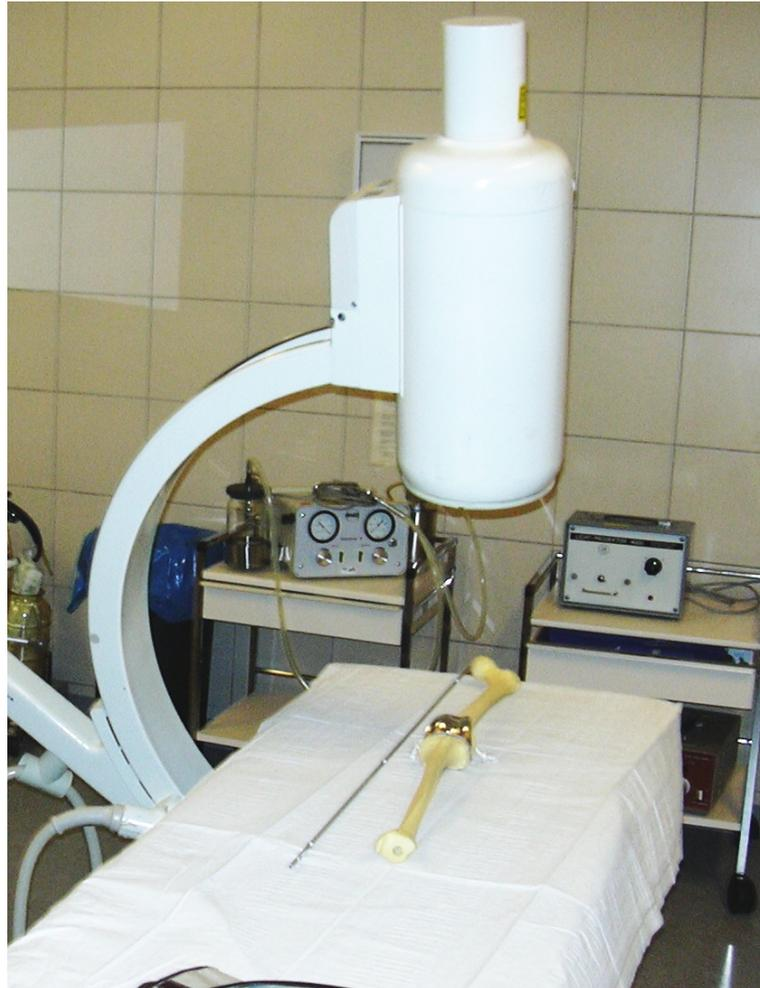
Abbildung 2.2: Der Kalibrierquader und der Stab werden zusammen mit dem künstlichen Knochen (an dem die Prothese angebracht ist) von dem C-Bogen aufgenommen.
