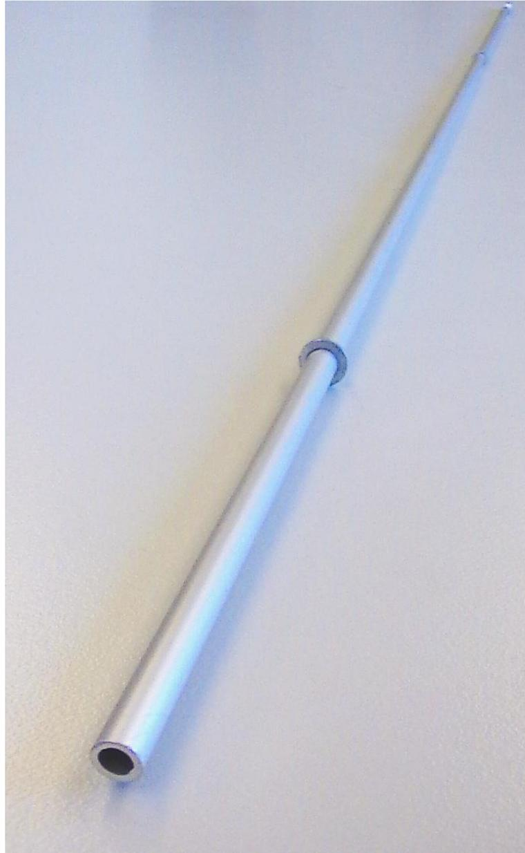
Abbildung 2.6: Der Kalibrierstab ist eine schmale Metallröhre, an der drei Metallringe als Markierungen angebracht sind.
