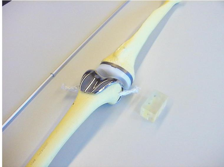
Abbildung 2.4: Der Kalibrierquader und der Stab müssen sehr dicht neben den Knochen gelegt werden, damit sie während der Aufnahme-prozedur möglichst vollständig in der Fluoroskopie-aufnahme abgebildet werden.
