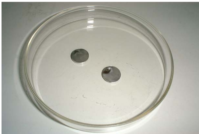
Abbildung 14: \text{Mg}/\text{Nb}_2\text{O}_5 -Elektroden, die mit 5 Gew.-% Graphit, 5 Gew.-% PTFE bei einem Druck von 6,2 \text{ N/mm}^2 komprimiert wurden.
