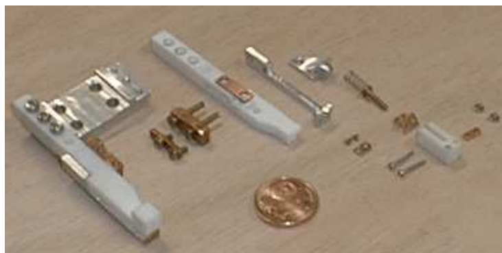
Abbildung 3.11: HERA-B-Gabelfuß des Schraub-Typs demontiert. Die Abbildung veranschaulicht den Aufbau eines Gabelfußes und demonstriert die große Anzahl der notwendigen Kleinteile.
