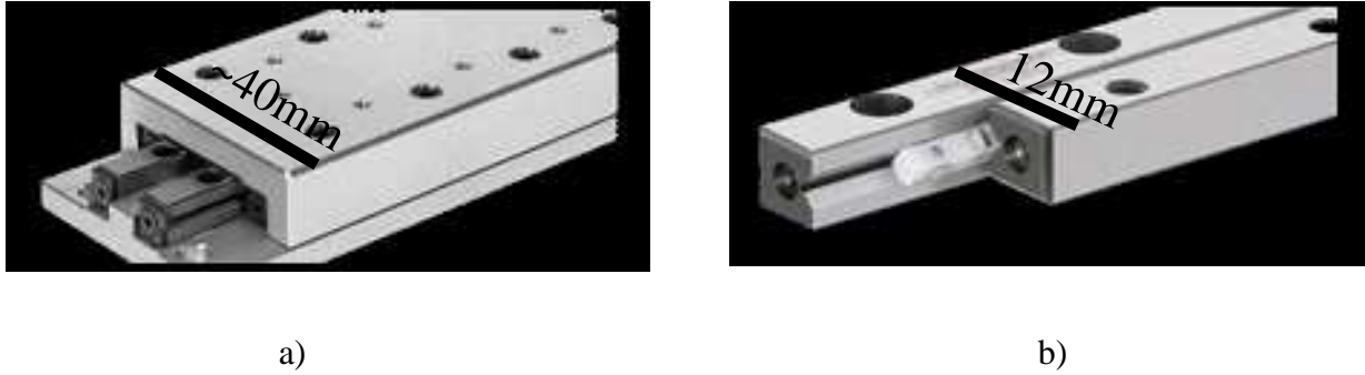
Abbildung 3.16: Abbildung a) zeigt den verwendeten Linearschlitten [Sch02], er besteht aus zwei Platten und zwei Führungen. b) zeigt das Prinzip der Kreuzrollenführungen [Sch02]. In einem Rollenkäfig aus Kunststoff sind um 90 Grad versetzt Rollen angeordnet, die zwischen den beiden Führungen laufen.
