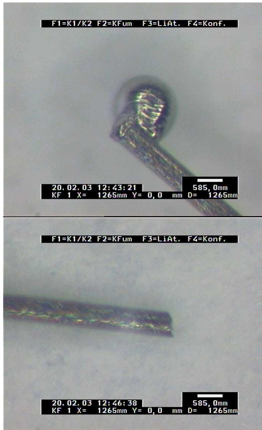
Abbildung D.1: Mikroskopische Aufnahme eines geschmolzenen Targetdrahtes. Der Durchmesser des Drahtes beträgt 50 \mu\text{m} .
