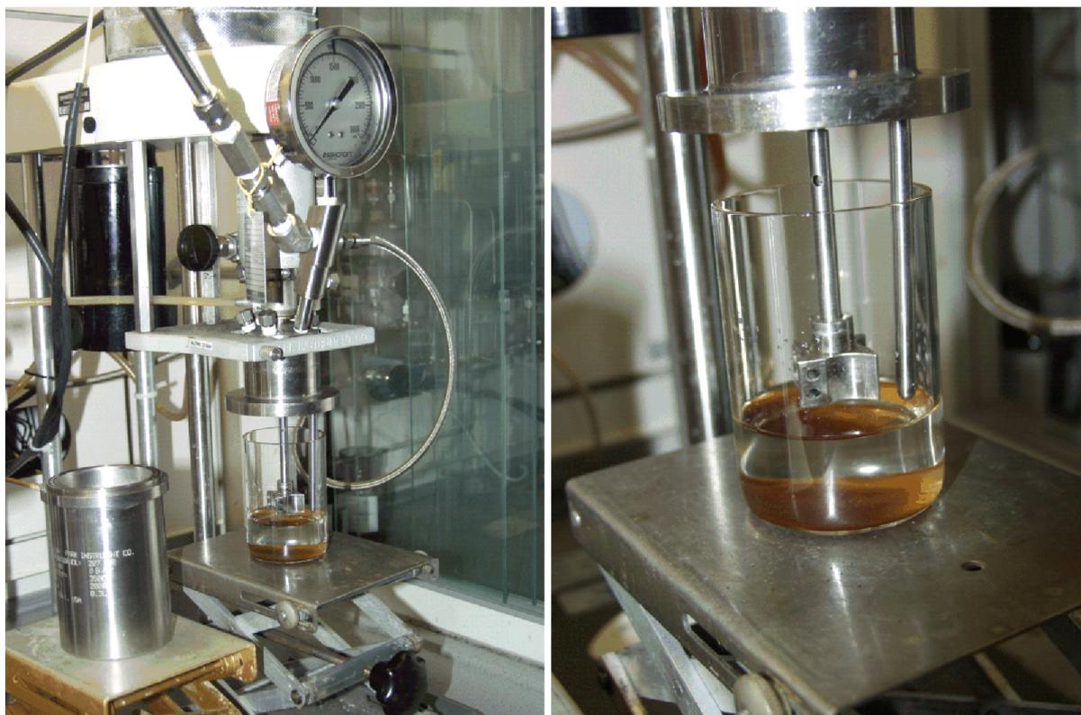
**Abb. 75:** Druckreaktoraufbau zur Hydroaminomethylierung an der festen Phase.
