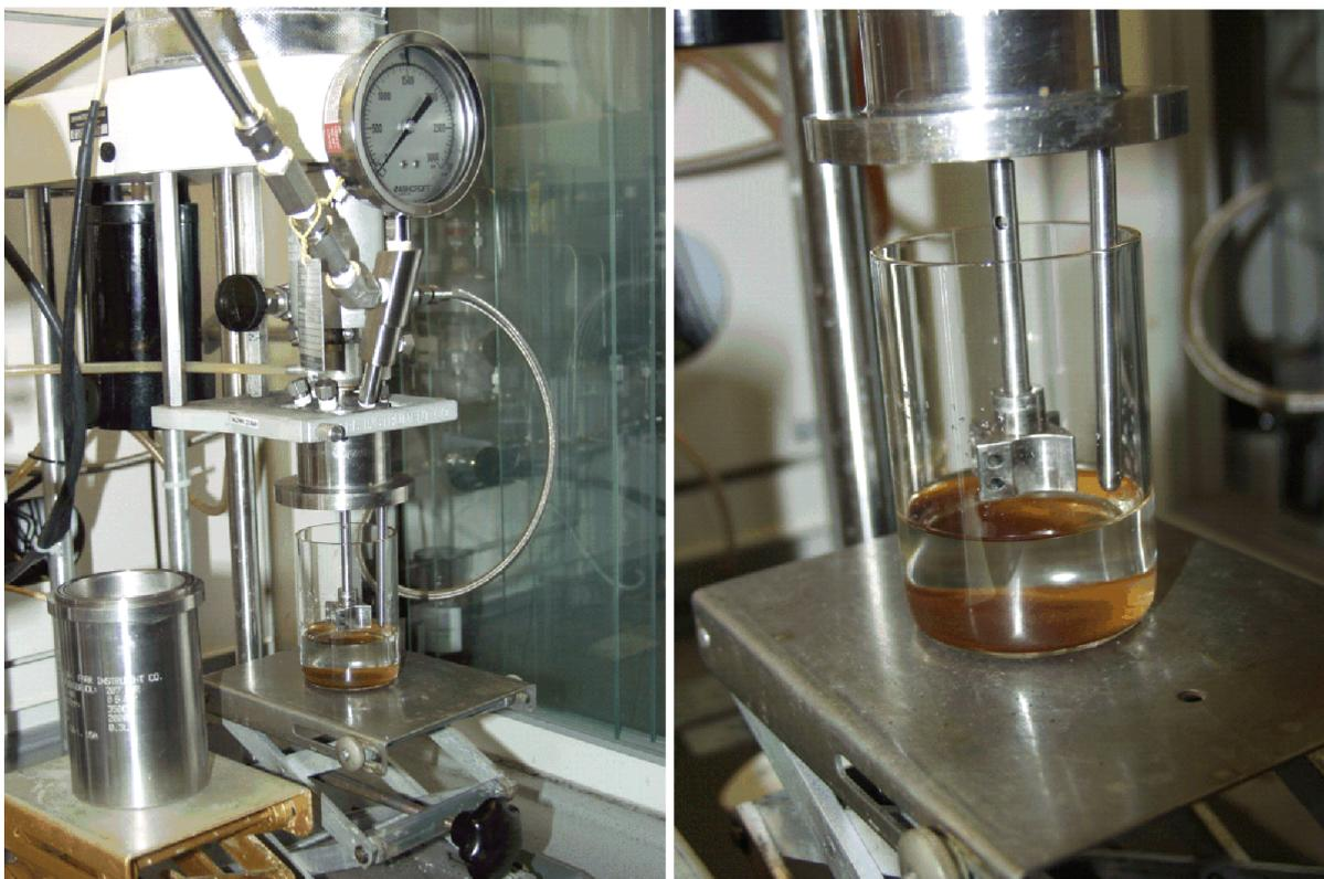
**Abb. 108 :** *Druckreaktorenaufbau zur Hydroaminomethylierung an der festen Phase.*
