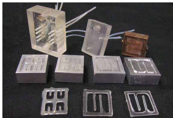
Abbildung 3.6: Ansicht der Dichtungen des Typs A und B, sowie der zugehörigen Gussformen und den verwendeten Rückseiten der Flusszellen.
