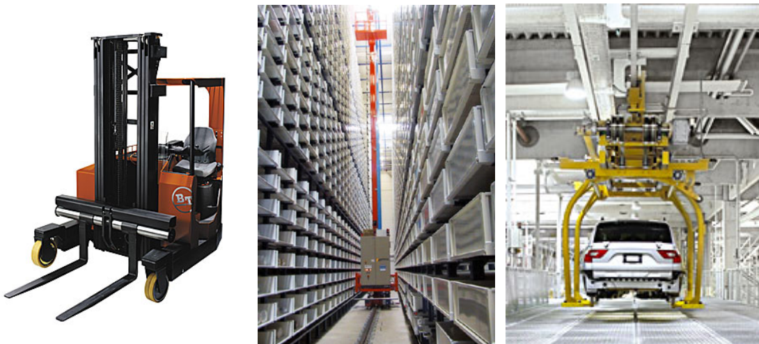
Abbildung 2.1: Beispiele für den Einsatz von Schwerlastrollen in logistischen Anwendungen: Gabelstapler /BT/, automatische Hochregallager /Armes/, Hängeförderer /Dürr/ (von links nach rechts)
