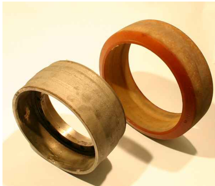
Abbildung 2.27: Ablösung einer Bandage von der Nabe eines Schwerlastrades, D = 270 \text{ mm} , B = 100 \text{ mm}
