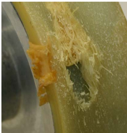
Abbildung 4.16: Schaden durch dynamische Überbeanspruchung im Vorversuch (links), Aufzeichnung des Temperaturverlaufs (rechts)
