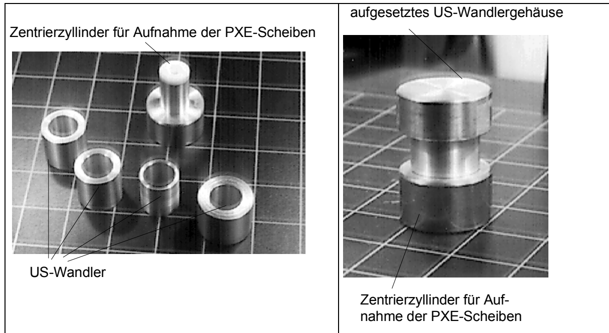
Abbildung 3.2-4: Fotografische Darstellung der US-Wandler und Zentrierzylinder
