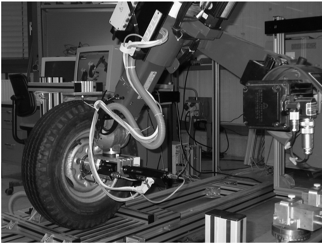
Abbildung 8.6: Ansicht der DEMON-Arbeitszelle während des Entschraubvorganges
