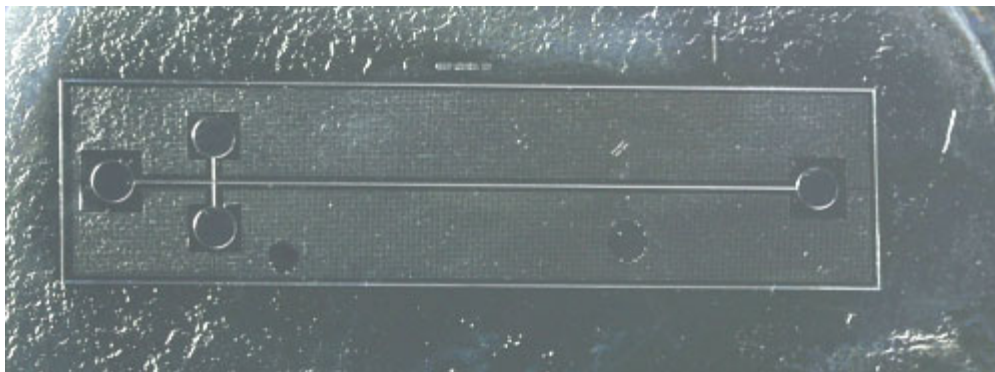
Abb. 3.8: Starke Oberflächenwelligkeit durch mangelnde Haftung der Metallschicht
