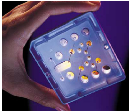
Abb. 1.1: Mikrostrukturierter Analysechip mit Fluidikstrukturen, Elektroden und Reservoiröffnungen [ CAL-01 ]
