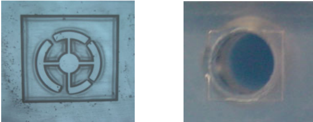
Abb. 3.7: a) Justagemarker im Substrat, b) gebohrte Justageöffnungen
