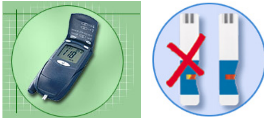
Abb. 1.10: Blutzuckermessgerät mit mikrofluidischem Bauteil [ ROC-02 ]
