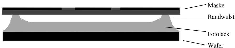
Abb. 3.11: Auswirkung einer Randwulst
