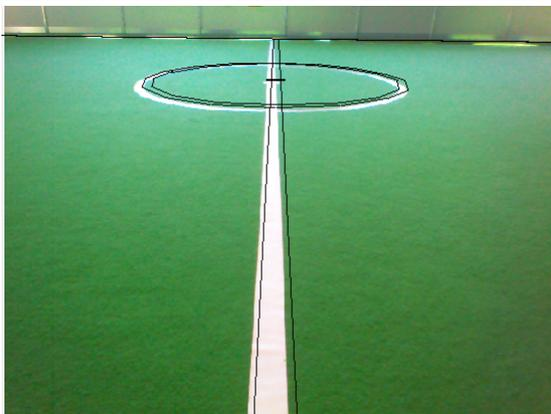
Hier wurde nun die `RobotPose` angepasst. Der Parameter `rotation` beträgt nun 1.549 statt den vorherigen 1.602. Beim oberen Bild ist nun noch eine parallele Verschiebung der Matrix nach rechts. Außerdem ist die Seitenlinie rechts weit über der Feldlinie und links ein wenig. Als nächstes wird nun der Kopf nach links und nach rechts bewegt um auch dort die Verschiebungen zu analysieren. Die untere Kamera wird erst zum Schluß kalibriert.
