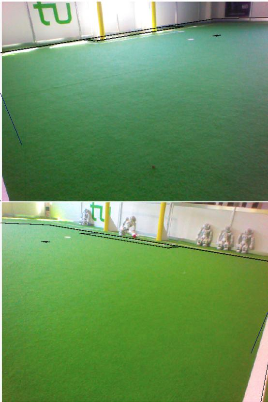
Das obere Bild zeigt die linke Blickrichtung. Die Matrix ist an der rechten Ecke nach oben gezogen. Bei der rechten Blickrichtung ist sie unter der Feldlinie. Dementsprechend muss der Parameter Roll angepasst werden und, wie beim Blick nach vorne festgestellt, muss der Tilt ein wenig nach unten korrigiert werden.
