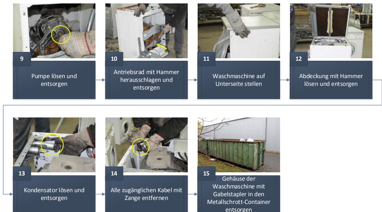
Abbildung 61: Arbeitsprozess – Demontage Waschmaschine
