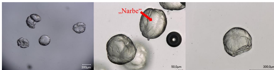
Abbildung 96: Aufnahmen von 9:1-PAAm h -Kapseln unter dem Mikroskop. Die Bilder mittig und rechts wurden mit der Funktion „Tiefenschärfe“ erstellt. Wässrige Phase: 20 ml Phase enthalten 15 ml Glycerin, 0,25 % PAAm h , 0,1 mM SHS, KOH, pH = 9. Ölphase: 10 ml Ölphase enthalten 10 mM Sebacinsäuredichlorid in p -Xylol/ 1,2,4-Trichlorbenzol der Dichte 1,243 g/cm 3 .
