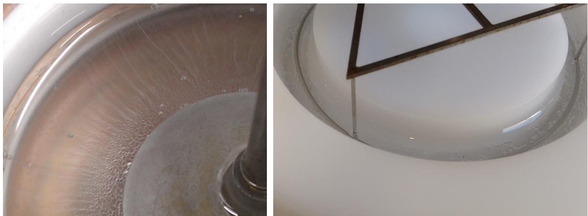
Abbildung 88: Oberflächenstruktur einer Polyacrylamid-Membran mit Sebacinsäuredichlorid als Vernetzer am ARES (links) und am DHR (rechts). Die Membran weist Falten und Bläschen auf. Abbildung links ist aus der Forschungsarbeit von Demand ([217] S. 23) entnommen.
