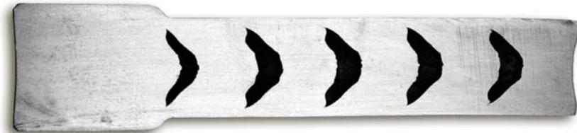
**Bild 2.22:** Fließgepresstes Bauteil (Werkstoff: 100Cr6) mit Chevron-Rissen (nach Soyarslan et al., 2008)
