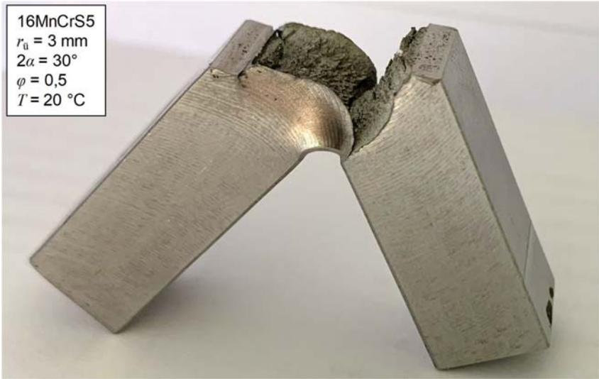
**Bild 7.29:** Verformungsbruch an einer Kerbschlagprobe bei  $T = 20 \text{ }^\circ\text{C}$
