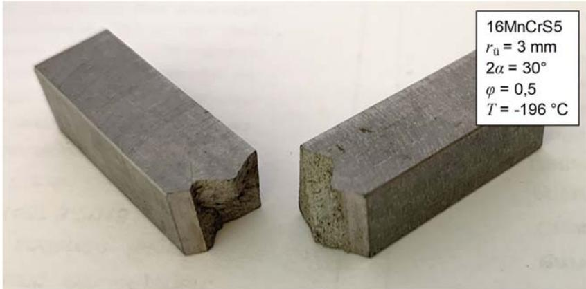
**Bild 7.31:** Sprödbbruch an einer Kerbschlagprobe bei  $T = -196\text{ °C}$
