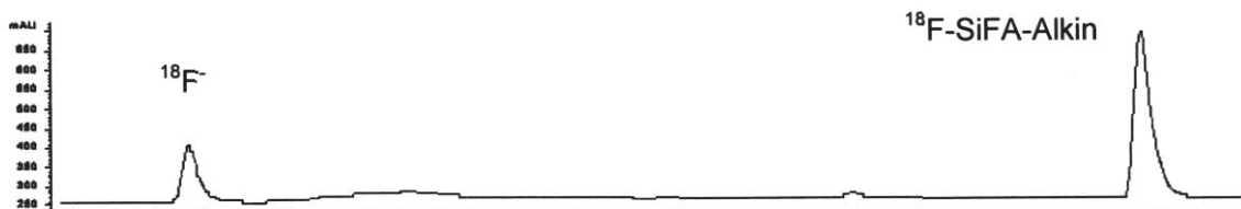
Abbildung 20: Radio-HPLC, repräsentiert den Reaktionsfortschritt des SiFA-Alkins mit [(n\text{-Bu})_4\text{N}]^{18}\text{F} eine Minute nach Vermischen der beiden Komponenten.
