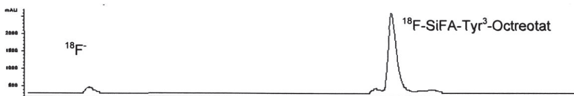
Abbildung 41: Radio-HPLC einer physiologischen (0.9% NaCl) Lösung des mit ^{18}\text{F} -markierten Tracers 21 60 min nach Anfertigung der injektionsfertigen Lösung.
