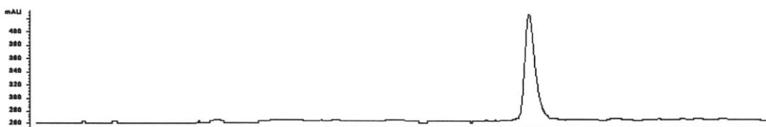
Abbildung 35: Radio-HPLC einer physiologischen (0.9% NaCl) Lösung der mit ^{18}\text{F} -markierten Aminosäure 45 min nach der Anfertigung der injektionsfertigen Lösung.
