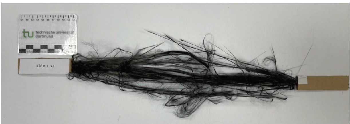
Bild A3-6: Bruchbild Faserstrangzugprobe – KSE 100 o. L. x2
