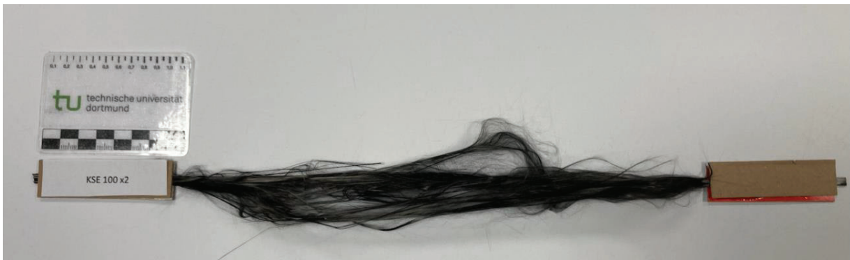
Bild A3-3: Bruchbild Faserstrangzugprobe – KSE 100 x2
