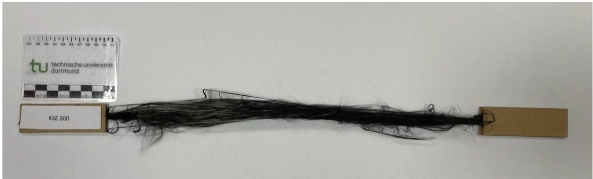
Bild A3-4: Bruchbild Faserstrangzugprobe – KSE 300
