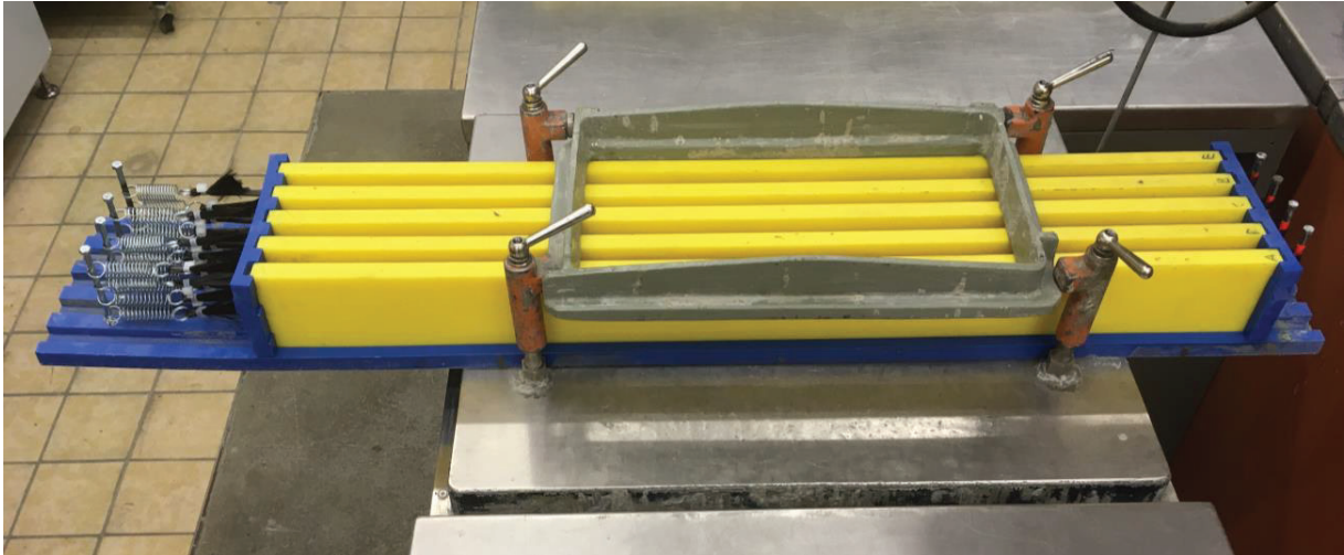
Bild 3-4: Kunststoffschalung mit getränkten Carbonrovings auf Rütteltisch befestigt
