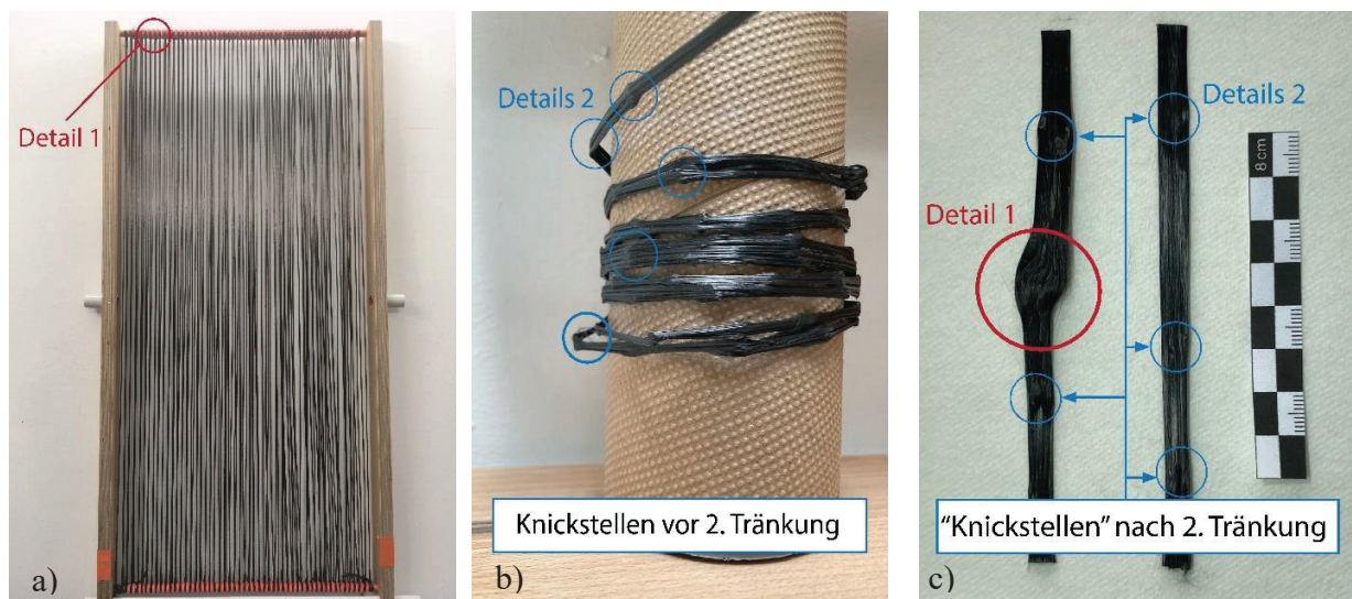
Bild 3-3: a) Propellerrahmen, b) Aufgerollte einfach getränkte Carbonendlosfasern, c) Aufweitung durch Propellerrahmen (1) und geglättete Knickstellen (2) nach zweiter Tränkung
