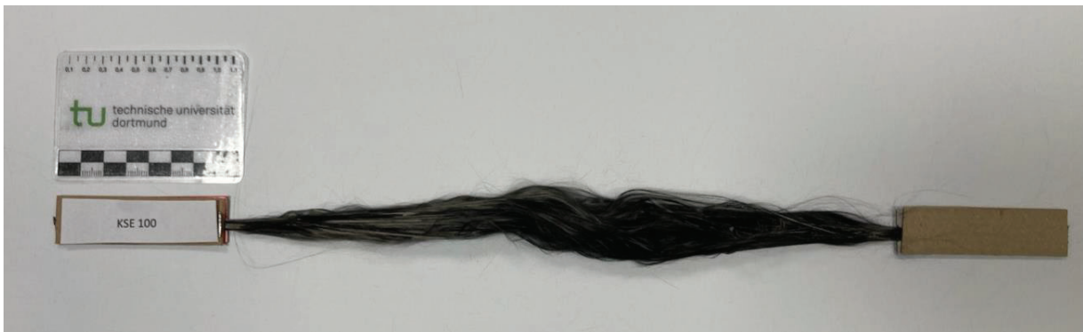
Bild A3-2: Bruchbild Faserstrangzugprobe – KSE 100
