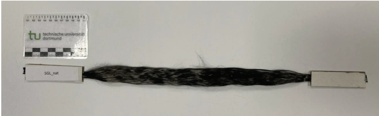
Bild A3-1: Bruchbild Faserstrangzugprobe – SGLnat (ungetränkt)
