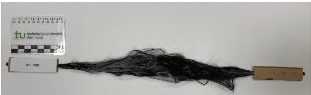
Bild A3-5: Bruchbild Faserstrangzugprobe – KSE 500 E
