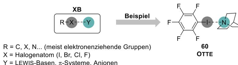
**Abbildung 2.15:** Schematische Darstellung einer Halogenbrücke und Beispiel eine molekularen Halogenbrücke **60** von F. OTTE.<sup>[94,95]</sup>
