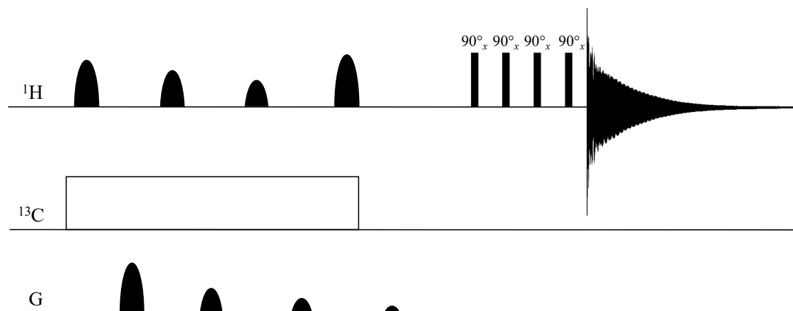
Abbildung 28: Schematische Darstellung einer WET Pulssequenz mit 13 C Entkopplung.
