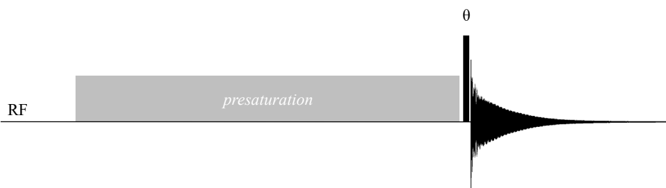
Abbildung 27: Schematische Darstellung der Presaturation Pulssequenz zur Lösungsmittelunterdrückung mit der Presaturation (Vorsättigung) der Lösungsmittelfrequenz und dem rf-Puls mit Flip Winkel \theta vor der Akquisition des FID.
