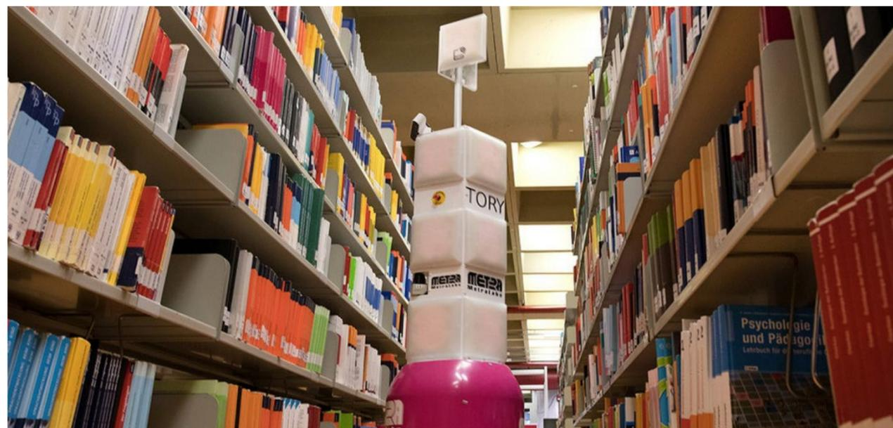
Roboter „Tory“ fährt selbstständig durch die Regalreihen der Universitätsbibliothek und hilft beim Sortieren der Medien. Über RFID-Signale findet er Bücher, die am falschen Platz stehen und deshalb nicht mehr aufgefunden werden. Seine Nutzungsmöglichkeiten gehen aber weit über die bloße Sortierung hinaus: Für den Neubau der Bibliothek ist geplant, eine Indoor-
