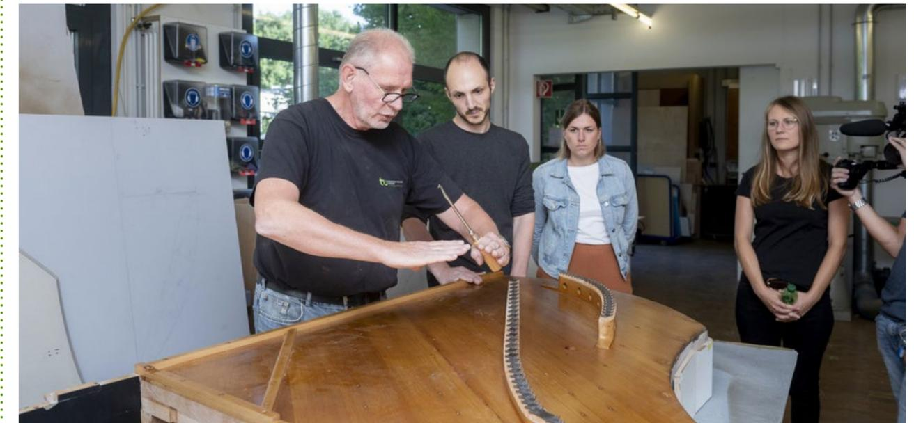
17 Architekturstudierende bauen einen knapp 115 Jahre alten Konzertflügel aus dem Hause Ibach im eigenen Design neu zusammen. Das Instrument wird in der Modellbauwerkstatt auseinandergebaut, dann werden alle bespielbaren Elemente wie Klaviatur und Pedale für den neuen Flügel verwendet. Für das Äußere des Instruments und einen dazugehörigen
