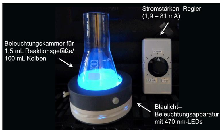
**Abbildung 17:** Blaulicht-Beleuchtungsapparatur mit integrierten 470 nm-LEDs für lichtabhängige *in-vitro*-Transkriptionsreaktionen.
