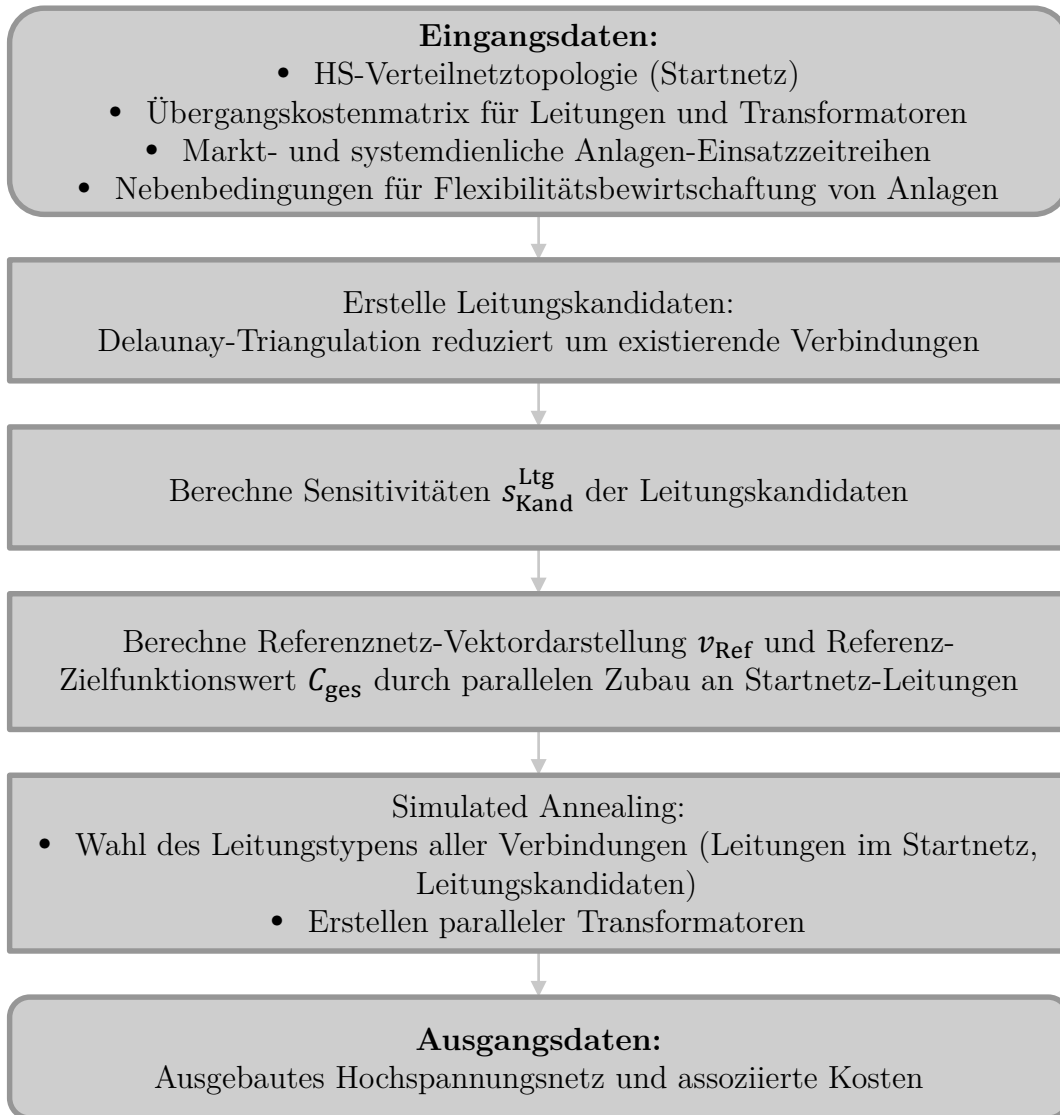
Abbildung 4.12: Übersicht der entwickelten Methode zum automatisierten HS-Netzaubau
