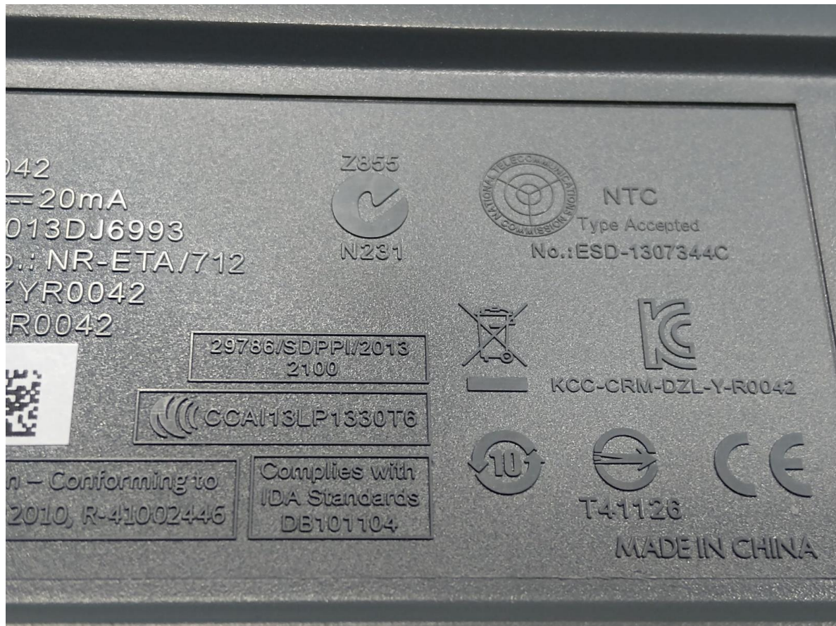
Abbildung 1 Kennzeichnung auf einer PC Tastatur, kontrastarm, erhaben aber taktil nicht erfassbar, da Schriftgröße und Erhabenheit unter den geforderten Mindestmaßen liegen (eigenes Foto)
