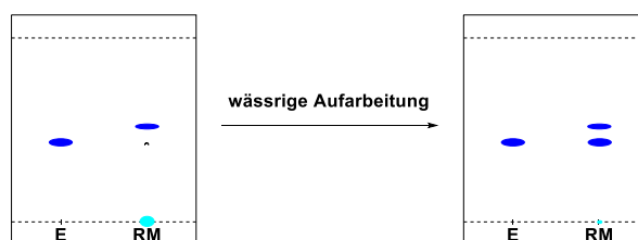
Abbildung 24 Schematische Darstellung einer Dünnschichtchromatographie (DC) der in Abb. 23 dargestellten Reaktion nach 2 h Reaktionszeit (links) und nach der wässrigen Aufarbeitung (rechts). (E: Edukt 13 , RM: Reaktionsgemisch).
