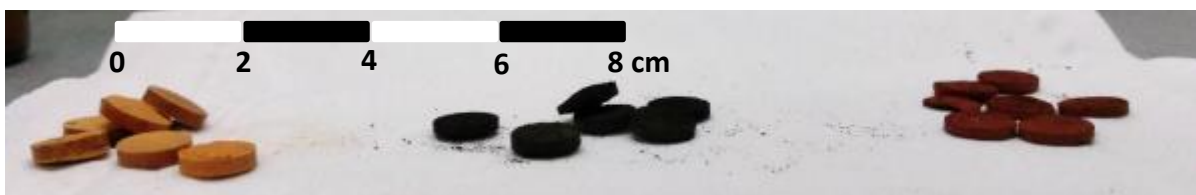
Abbildung 4.6: Hergestellte \text{FeBr}_2 (links), \text{Fe}_3\text{O}_4 (mittig) und \text{Fe}_2\text{O}_3 -Pellets (rechts).
