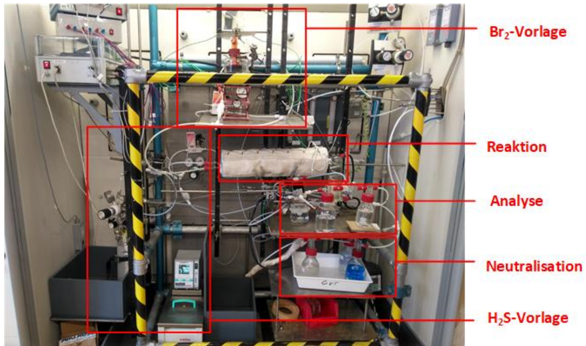
Abbildung 2.5: Aufbau der Anlage zur Bromierung von Schwefelwasserstoff.
