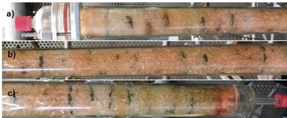
Abbildung 7.4: Reaktor nach Versuchsende mit einem max. Fe 3 O 4 -Verbrauch von 79,5 %, a) oben, b) Mitte und c) unten.
