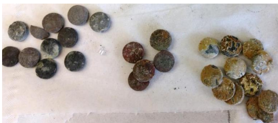
Abbildung 4.11: Aus dem Reaktor entnommene Pellets mit verschiedenen Färbungen bei max. \text{Fe}_3\text{O}_4 -Verbrauch von 100 %; Links: unterer Reaktorteil, rechts: oberer Reaktorteil.
